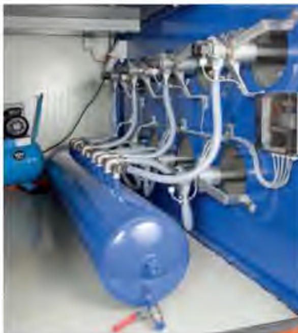
Рис. 11.26. Система очистки фильтра сжатым воздухом
