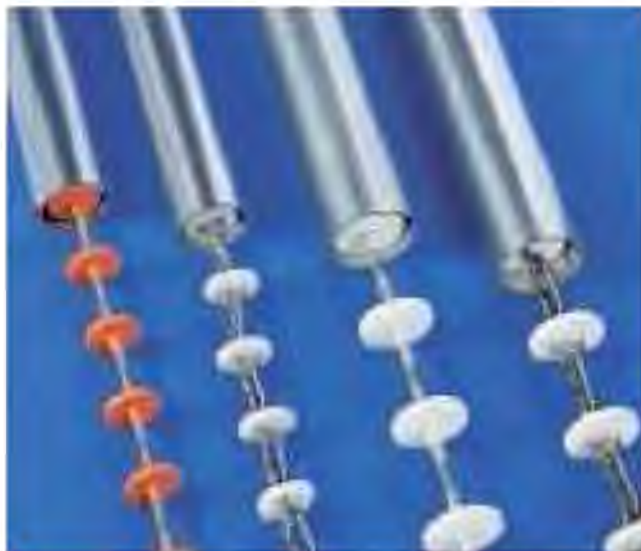
Рис. 3.8. Кормопровод с транспортной цепью (тросом) и заборными шайбами
