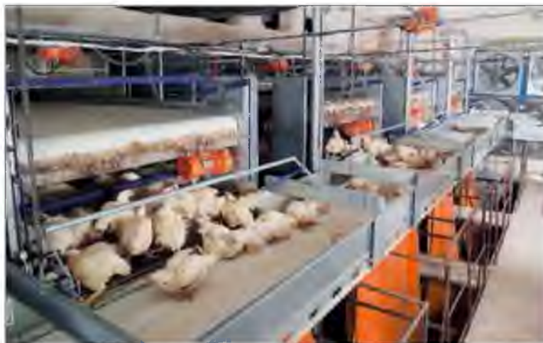
Рис. 7.16. Клеточная батарея с автоматической выгрузкой бройлеров
