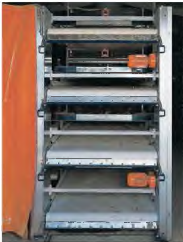
Рис. 7.8. Конечная станция пометоудаления с помето-приемной шахтой
