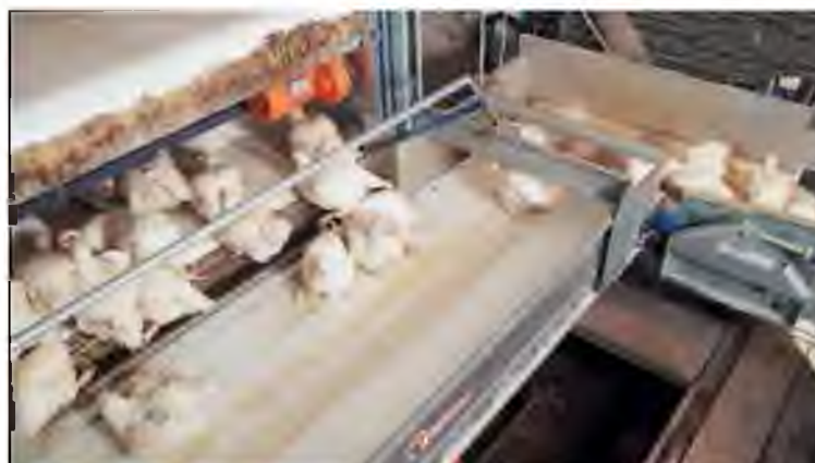
Рис. 7.17. Клеточная батарея с автоматической выгрузкой бройлеров
