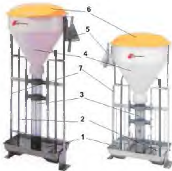
Рис. 3.5. Бункерные самокормушки MaxiMat компании Skiold, установленные в групповых станках для доращивания поросят: 1 – корыто (поддон); 2 – автопоилки nippleные; 3 – спускная (направляющая) труба; 4 – конический бункер; 5 – устройство для дозирования кормов; 6 – крышка откидная; 7 – каркас
