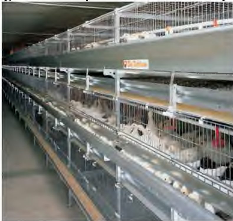
Рис. 7.3. Клеточная батарея UNIVENT Starter с ленточным удалением помета
