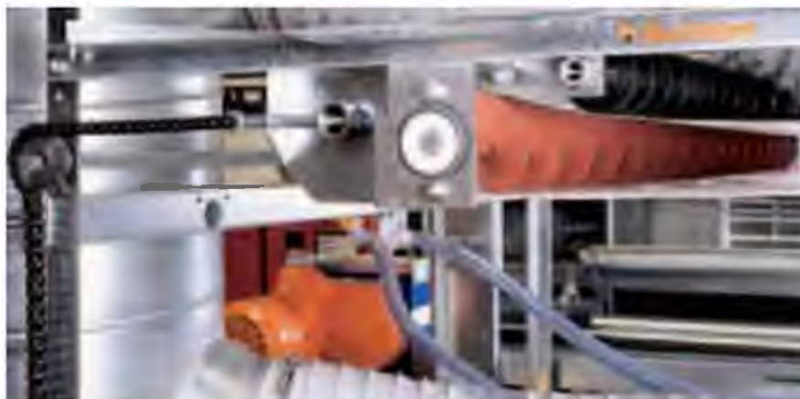
Рис. 7.1.4 Поворотная станция пометоудаления с очищающим шнеком
