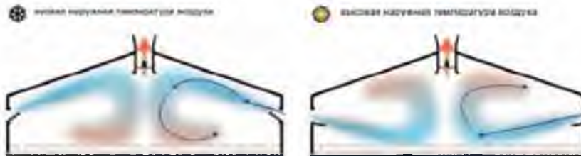
Рис. 11.3. Распределение воздуха в птичнике с применением стенных клапанов
