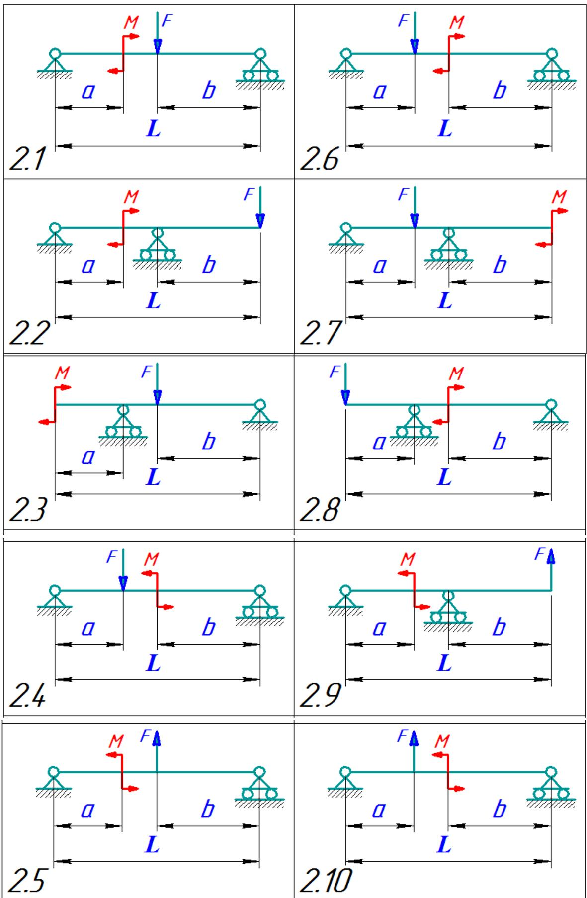
Рисунок 8.2 – Схемы нагружения балок к таблице 8.2
