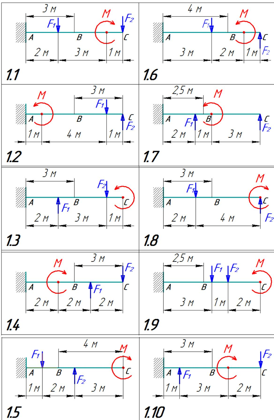
Рисунок 8.1 – Схемы нагружения балок к таблице 8.1
