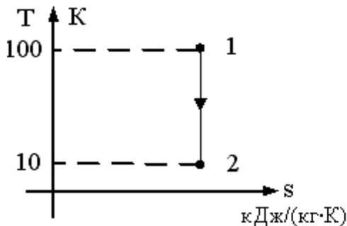
$T_1 = 100\text{K}$ ,  $T_2 = 10\text{K}$ ,  $\nu_1 = 1 \text{ м}^3/\text{кг}$ ,  $k = 2$ . В точке 2 адиабатного процесса, представленного на графике, удельный объем равен....
