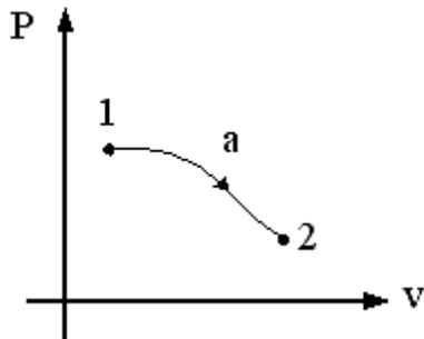
Если  $P_1 = 3 \cdot P_2$ ,  $v_1 = v_2/3$ , то изменение энтальпий  $\Delta h = h_1 - h_2$  в процессе 1-2, показанном на графике, равно...
