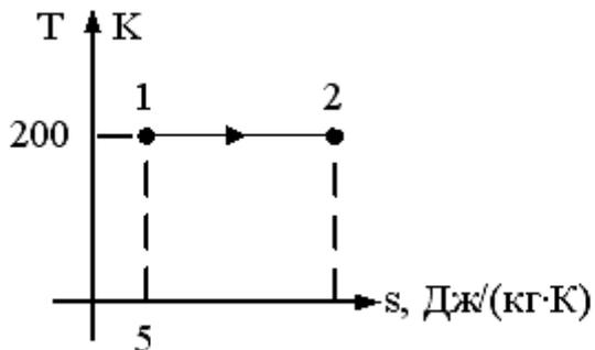
Если количество теплоты, которое подводится в изометрическом процессе 1 -2 равно 500 Дж/кг, то энтропия в точке 2 равна...
