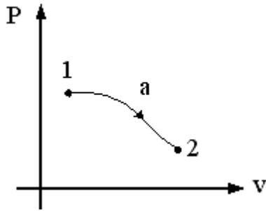
Если  $P_1 = 3 \cdot P_2$ ,  $v_1 = v_2/3$ , то изменение энтальпий  $\Delta h = h_1 - h_2$  в процессе 1-2, показанном на графике, равно...
