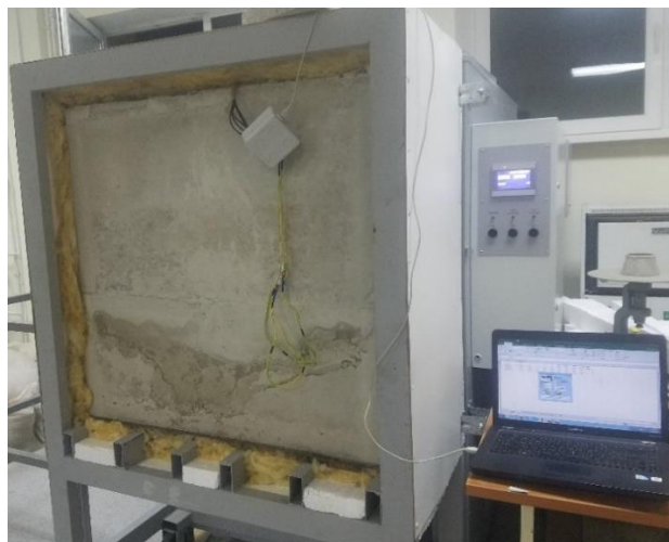
Рисунок 9 – Фотография установки для испытания стеновых ограждений с установленным макетом стены в научно-исследовательской лаборатории Кубанского Государственного Технологического Университета
