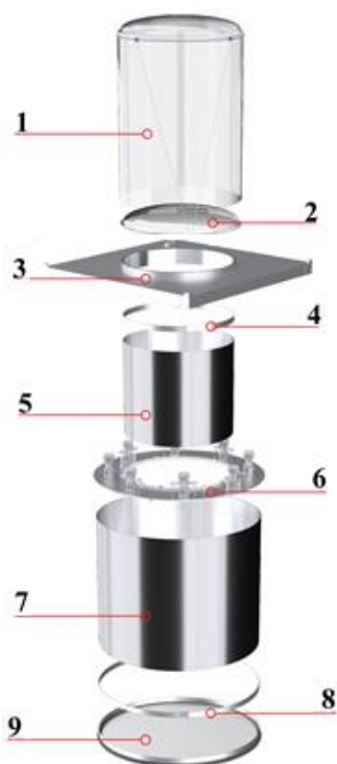
Рисунок 2 – Декомпозиция гибридной системы освещения Solar LED-S
