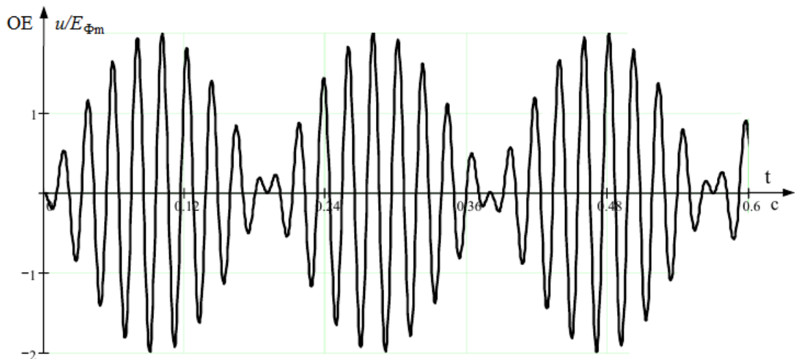
Рисунок 6.14 – Восстанавливающееся напряжение на поврежденной фазе после гашения дуги при \nu = 0,2 ; d = 0 (недокомпенсация ДГР)
