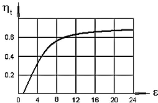
При  $v_1 = 1 \text{ м}^3/\text{кг}$ ,  $v_2 = 0,1 \text{ м}^3/\text{кг}$  термический КПД ДВС в соответствии с представленным графиком равен....
