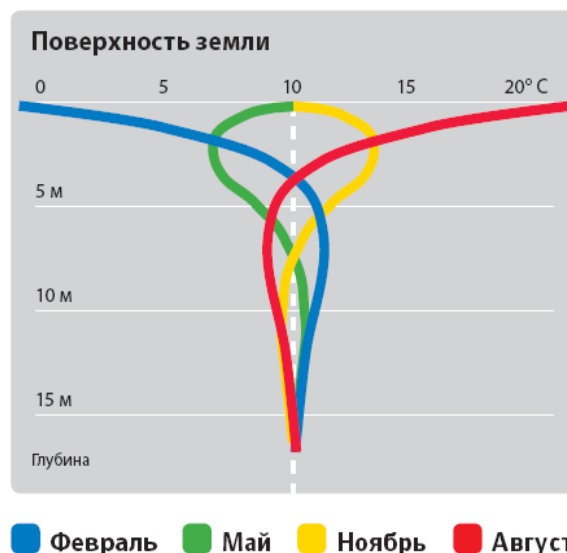
Рисунок 2.29 – График зависимости температуры грунта от глубины скважины в разное время года
