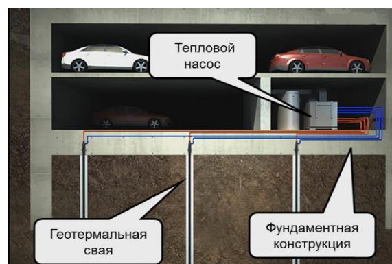
Рисунок 2.30 – Принципиальная схема свайно-плитного фундамента из геотермальных свай
