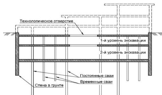
Рисунок 2.34 – Принципиальная схема технологии «top-down»
