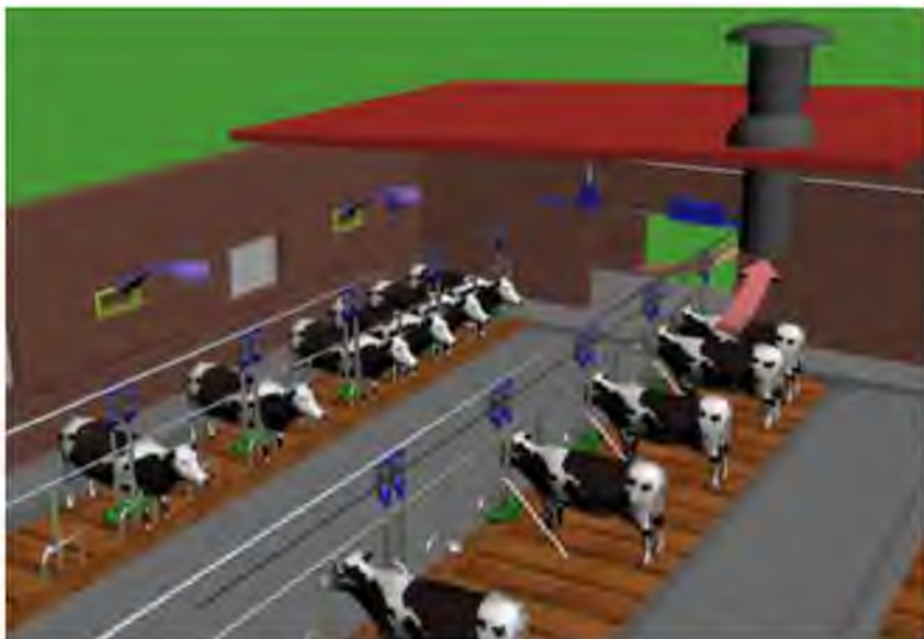
Рисунок 8.7 – Коровник, оборудованный приточно-вытяжной системой вентиляции
