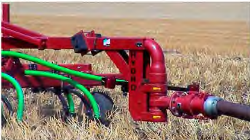
Рисунок 7.33 – Шарнирная труба для защиты шлангов
