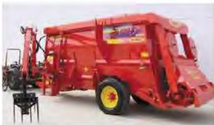
Рисунок 1.20 – Кормосмеситель (объем 12 м 3 ) с фрезерной или грейферной загрузкой
