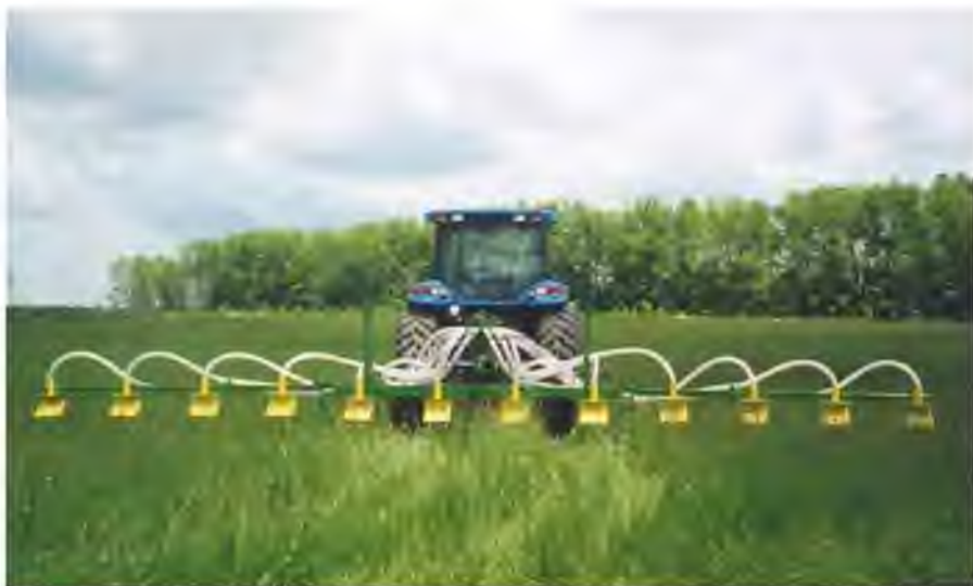
Рисунок 7.32 – Аппликатор для поверхностного внесения жидкого навоза
