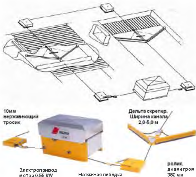
Рисунок 6.3 – Схема и общий вид дельта-скреперной установки
