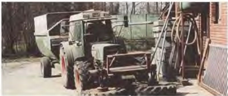
Рисунок 2.23 – Кормосмеситель в сочетании с устройством для удаления остатков кормов
