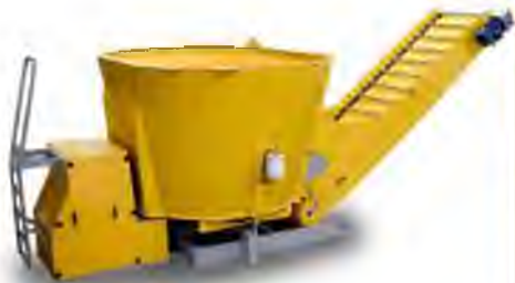
Рисунок 3.30 – Стационарный измельчитель-смеситель кормов а) общий вид; б) рабочий орган
