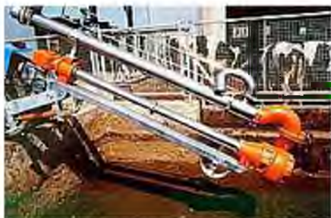
Рисунок 7.46 – Вертикальный погружной насос серии РТ передвижной
