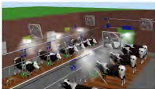
Рисунок 8.10 – Расположение вентиляторов в зоне приточных клапанов
