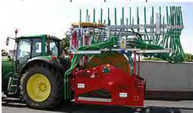
Рисунок 7.38 – Шланговый многошланговый распределитель с гидравлическим складным механизмом
