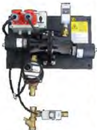
Рисунок 4.8 – Прибор для подогрева и циркуляции воды в системах поения
