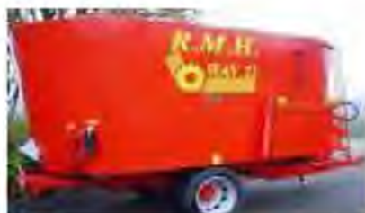
Рисунок 3.15 – Кормораздатчик RMH WAV 22 (Израиль)
