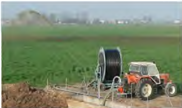
Рисунок 7.39 – Самодвижущаяся дождевальная машина для внесения жидкой фракции навоза
