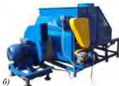
Рисунок 3.24 – Измельчители соломы стационарные а – ИСС-180; б – ИС-2000
