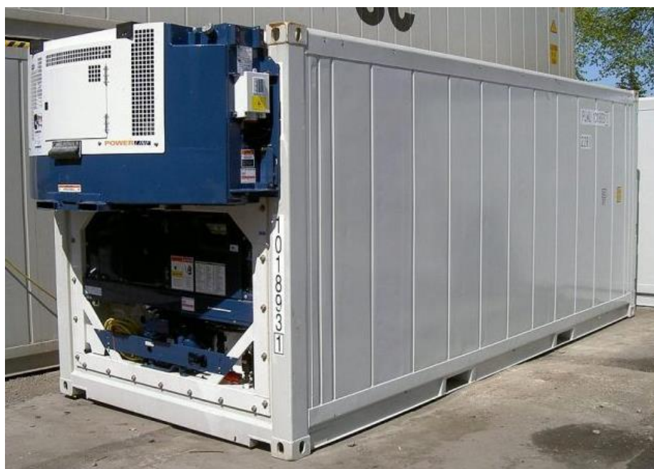
Рис. 53. Общий вид мобильной холодильной установки
