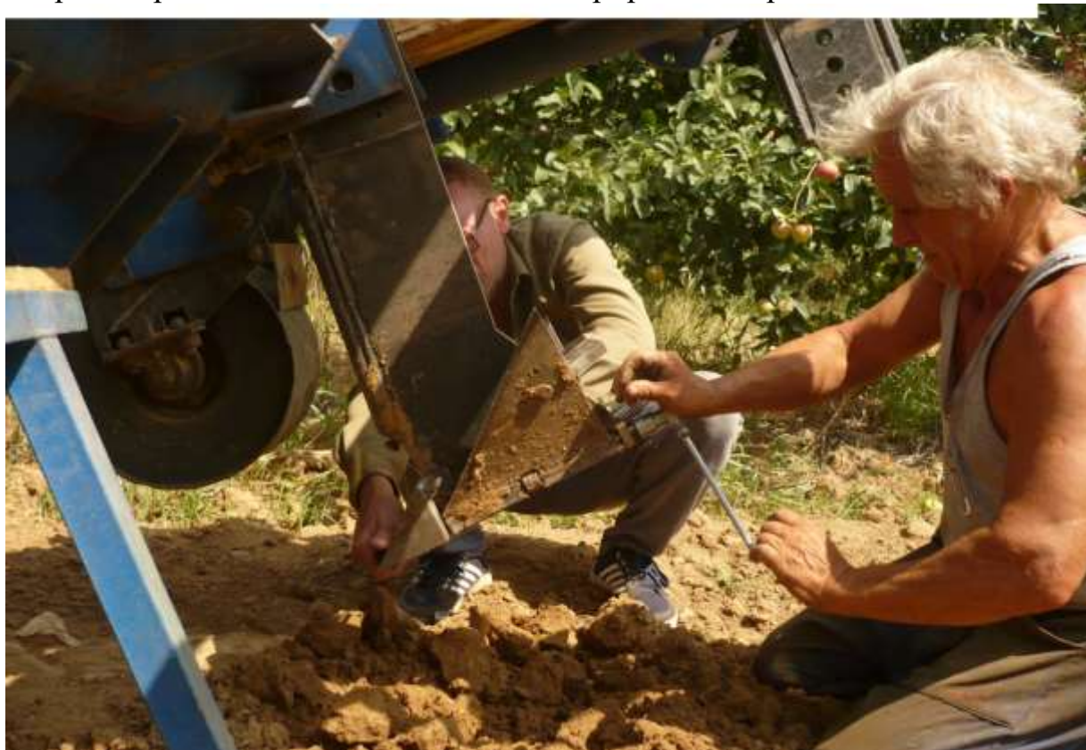
Рисунок 9.15 – Смена долота универсального рабочего органа для обработки почвы в процессе эксперимента
