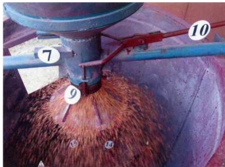
Рисунок 12.4 Процесс распределения семян при их сходе с распределительного конуса.
