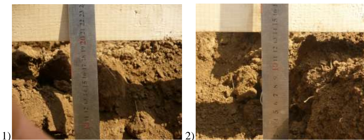
Рисунок 9.22 – Измерение глубины обработки после прохода рабочих органов
