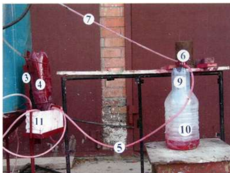
Рисунок 12.7 - Настройка и определение производительности распылителей.
