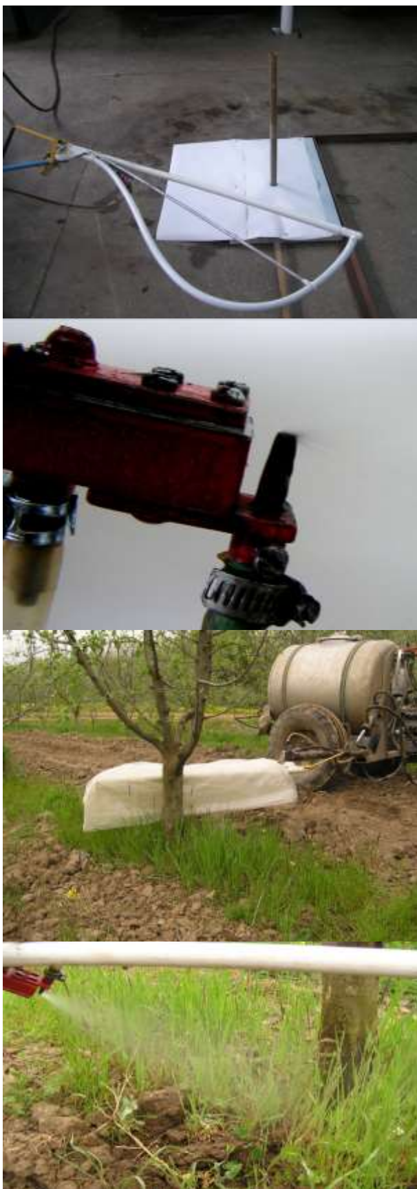
Рисунок 11.1 - Лабораторно-полевая (вверху) и полевая установка (внизу), и пневматический щелевой распылитель в работе
