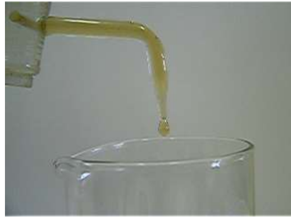
Рисунок 11.8 - Определение поверхностного натяжения рабочей жидкости по способу отрыва капли
