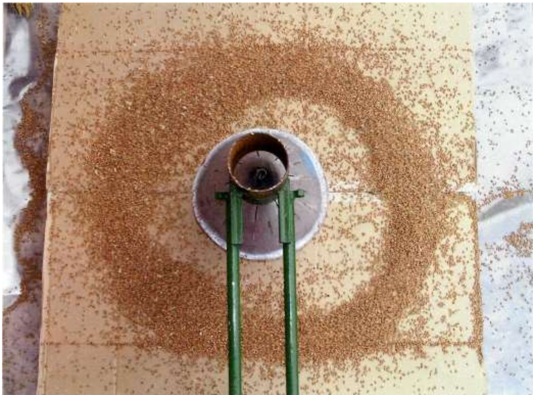
Рисунок 12.16. - Характер распределения сходящего потока с поверхности конуса при \alpha = 60^\circ .
