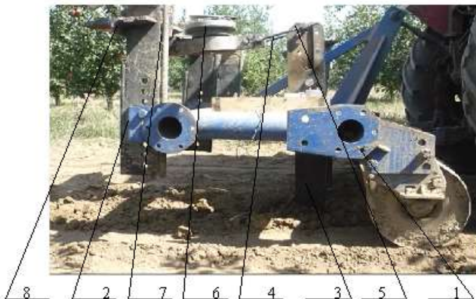
Рисунок 9.1 – Установка для определения тягового сопротивления рабочего органа.
