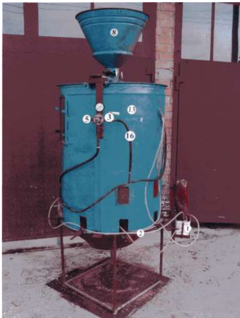
Рисунок 12.1 Общий вид лабораторной установки для протравливания семян.
