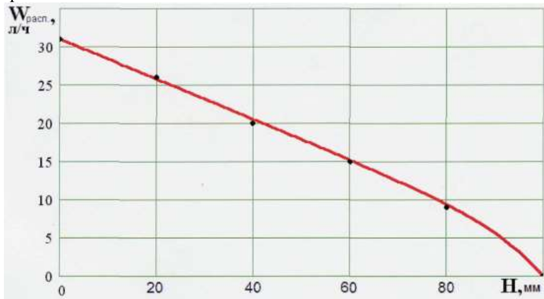
Рисунок 12.19. - Зависимость производительности распылителей ( W_{расп.} ) при 0,15МПа от высоты ( H ) питательной емкости.
