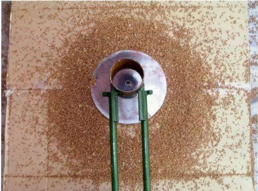
Рисунок 12.15. - Характер распределения сходящего потока с поверхности конуса при \alpha = 30^\circ .
