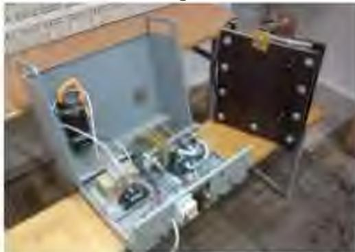
же в устройство автоматизации входит реле потока, и датчики тока. Реле потока в свою очередь отключает блок управления тиристорами, когда прекращается подача воды. Стабилизатор тока поддерживает заданное значение тока, а значит и значение pH, так как pH воды зависит от величины тока проходящего через рабочий орган электроактиватора
