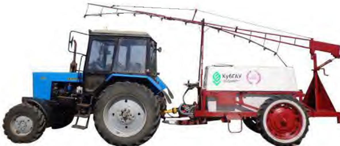
Рисунок 1 – Опрыскиватель КАМЫШ-2000
