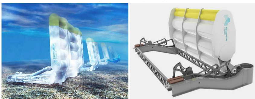
Рис. 4.5 – Конструкция волнового генератора типа «Oyster - 2»
