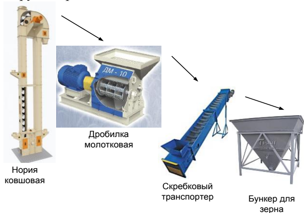
Рис. 5.3 – Технологическая схема линии предварительной обработки зерна
