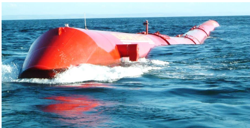
Рис. 4.3 – Макет волнового преобразователя для получения электрической энергии
