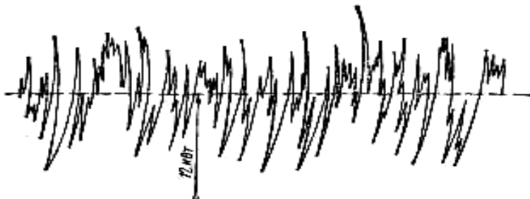
Рис. 6.7 – Приводные характеристики дробилок и измельчителей кормов
