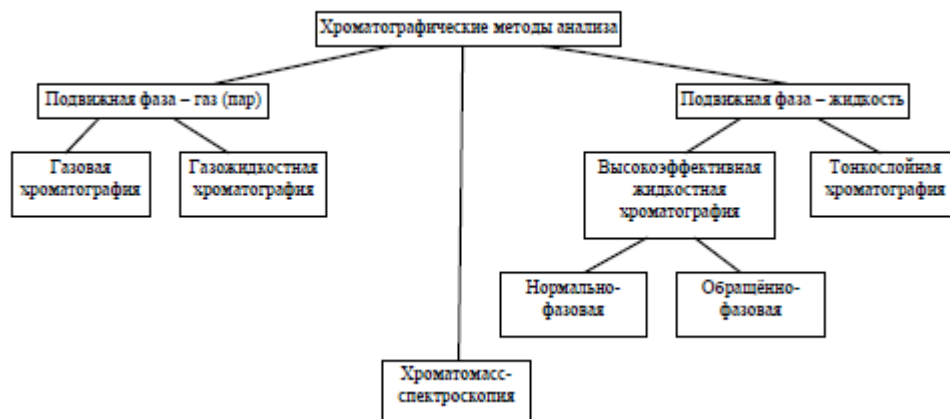
Рис. 4. Хроматографические методы анализа загрязняющих веществ
