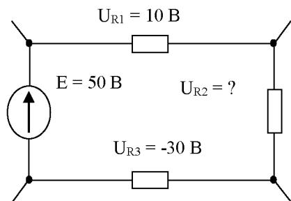
8. Определить мощность, потребляемую схемой
