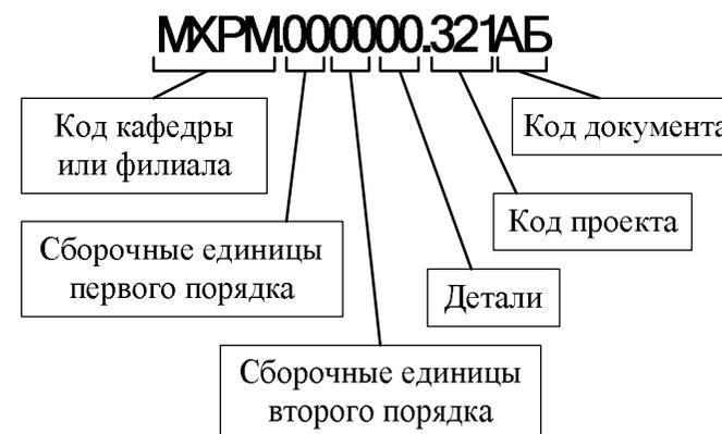
Рисунок 10 – Структура обозначения изделия и основного конструкторского документа
