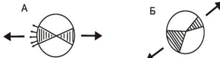
Рисунок 1.52 Фазы скольжения вороха по соломотрясу: а - для горизонтального соломотряса; б - для наклонного соломотряса
