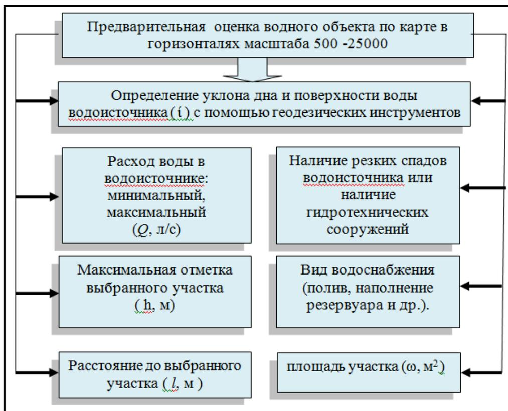
Рисунок 2 - Последовательность предварительного обследования местности
