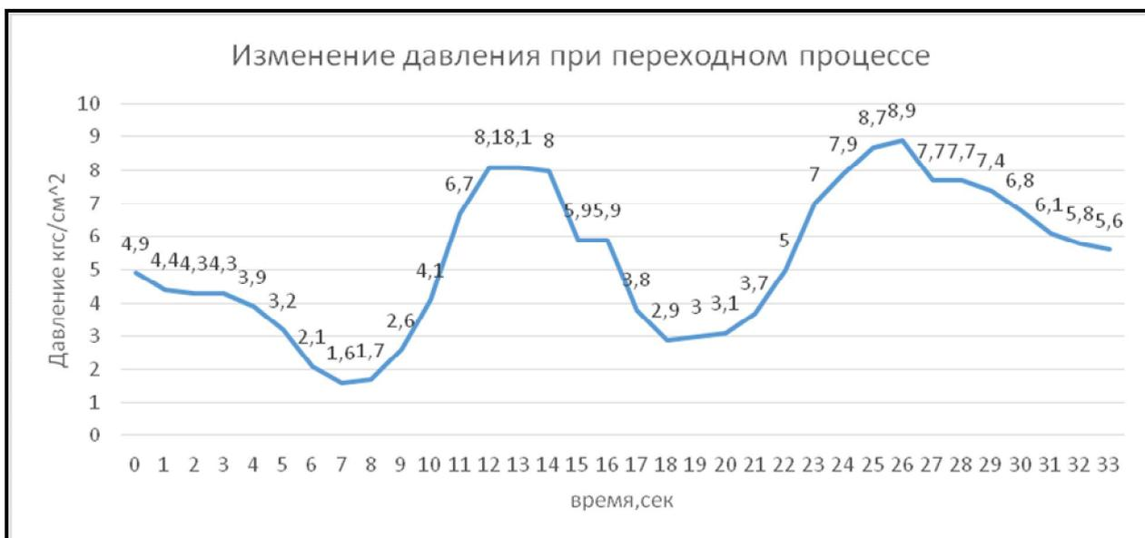
Рис. 2. График колебаний давления, полученный в результате натурных испытаний на насосной станции
