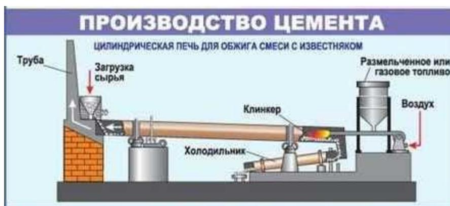
Рисунок 1 – Схема производства цемента
