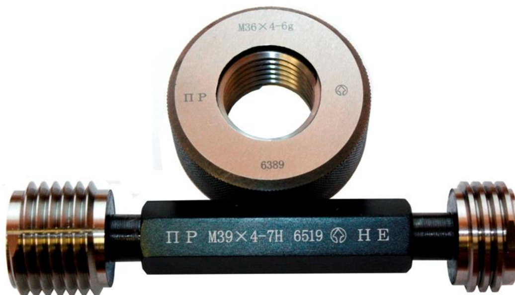
Рисунок 7.7 – Предельные резьбовые калибры: двусторонняя пробка и резьбовое кольцо
