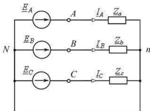
В изображенной схеме с симметричной системой ЭДС  $\underline{E}_A, \underline{E}_B, \underline{E}_C$  соотношение  $U_{\text{л}} = \sqrt{3}U_{\phi}$  выполняется \_\_\_\_\_ нагрузке (нагрузках).
