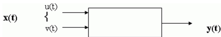
Рис.5.6 — Динамическая модель «черного ящика»: задание процесса на входах и выходах системы
