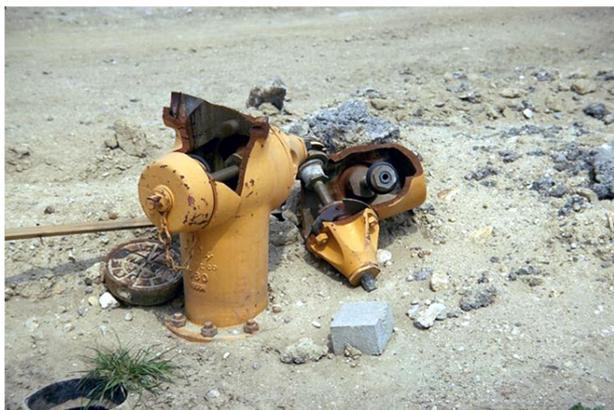
Рисунок 7.35 – Разрушение гидранта из-за гидравлического удара
