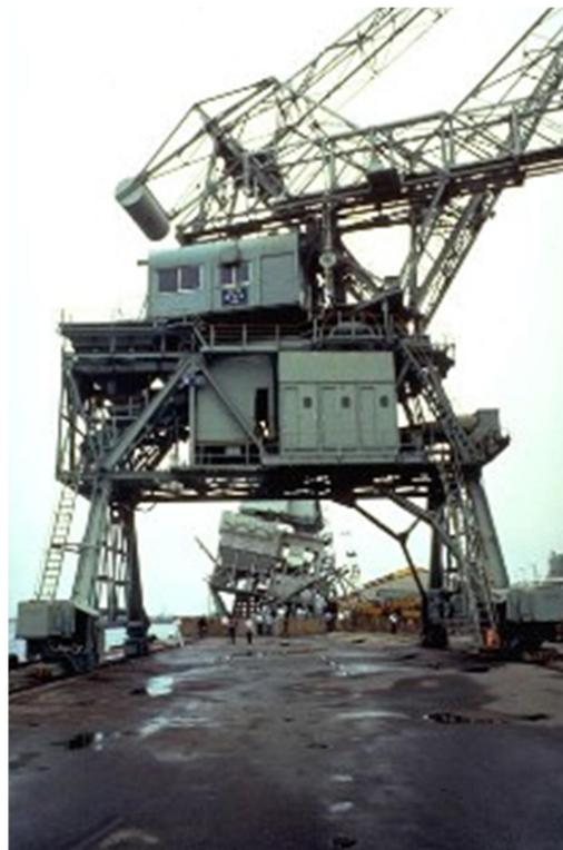
Рисунок 7.80 – Сейсмическое повреждение портового крана
