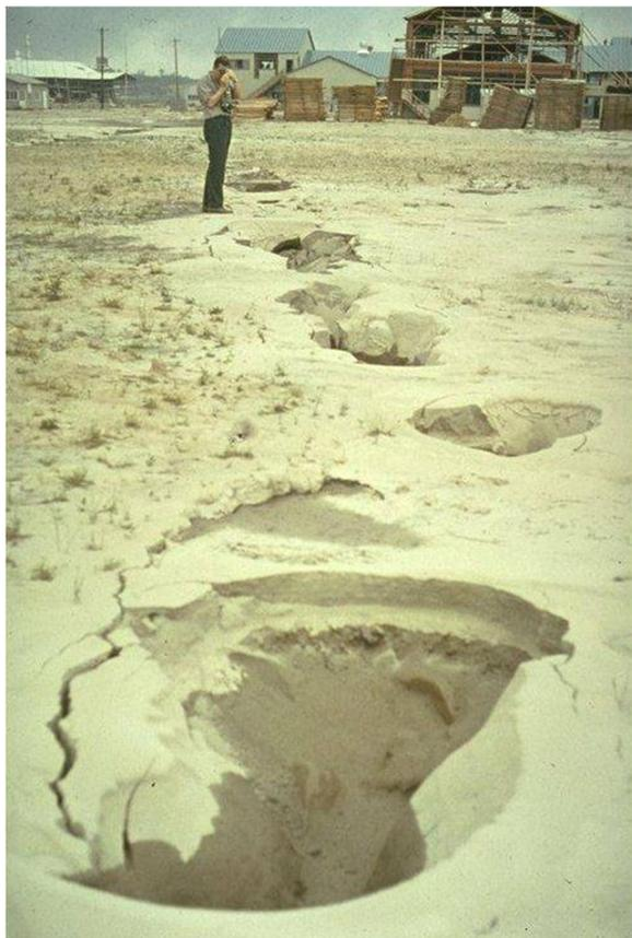
Рисунок 1.9 – Песчаные гейзеры, образовавшиеся при разжижении намывного песчаного основания во время прохождения продольной сейсмической волны (Япония, Кобе)
