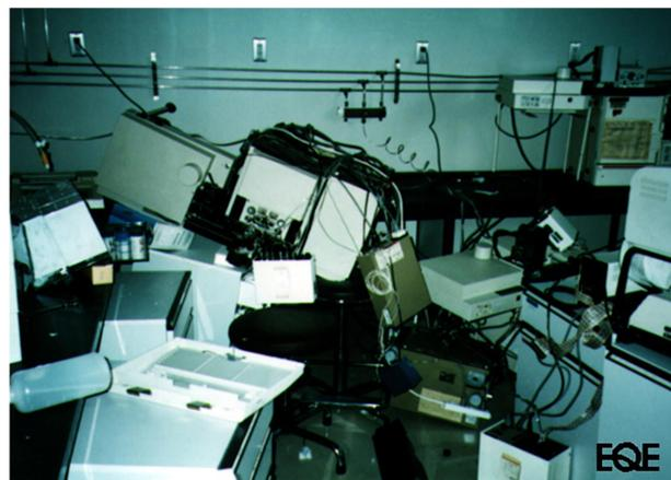
Рисунок 7.42 – Незакрепленное оборудование
