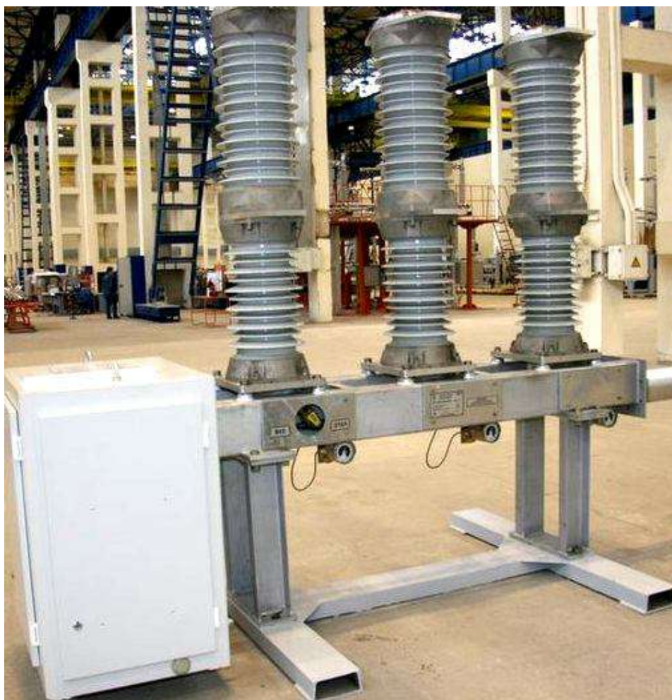
Рисунок 5.2 – Конструкция колонкового выключателя серии ВГТ 35
