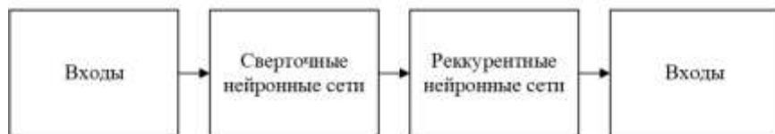
Рисунок 1 - Каскадная схема объединения нейронных сетей
