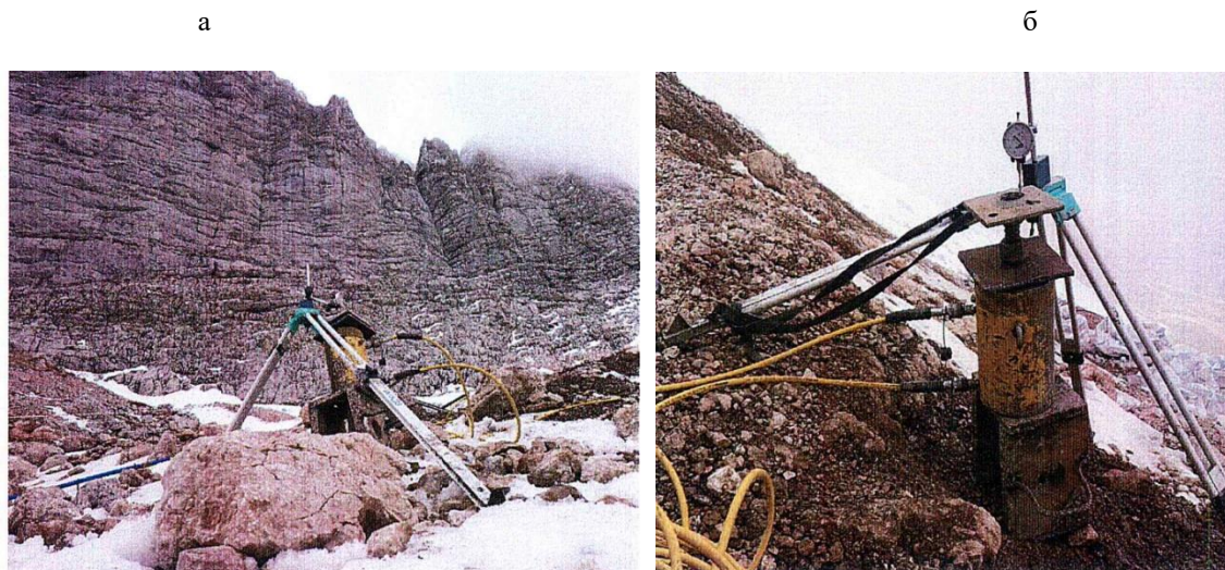
Рисунок 3 – Общий вид испытательной установки (а) и этап передачи вертикальной нагрузки на испытываемую сваю (б) Figure 3 – General view of the test installation (a) and phase of transfer of vertical load to the pile under test (b)
