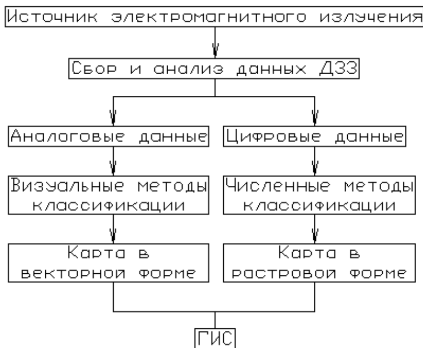
Рисунок 1 – Процесс сбора данных ДЗЗ
