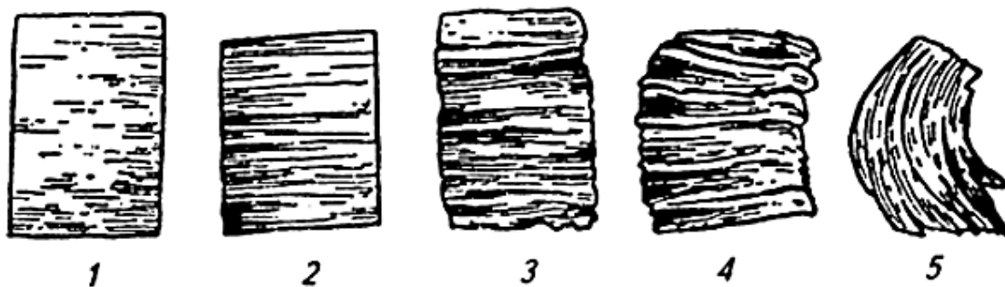
Рисунок 8 – Оценка консистенции масла пробой на срез:
