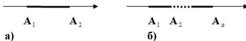
Рис. 44 – Точки эксперимента в однофакторном анализе: а) два уровня A_i, i=1,2;
