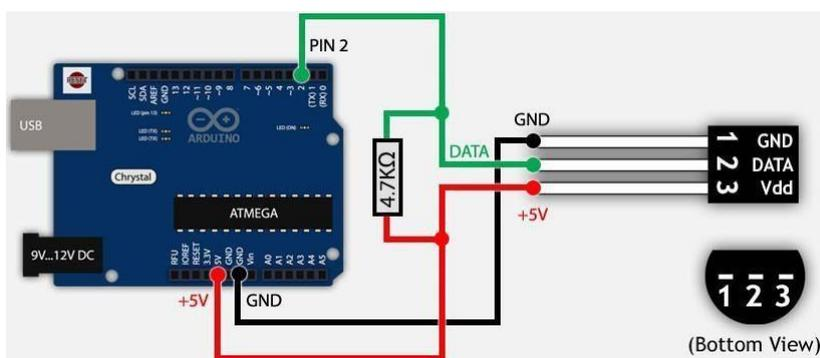
Рисунок 1.3 – Подключение датчика температуры DS18B20 к Arduino
