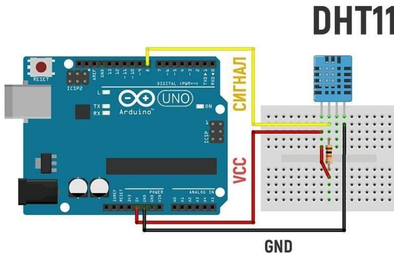
Рисунок 2.2 – Подключение датчика влажности DHT11к платформе Arduino
