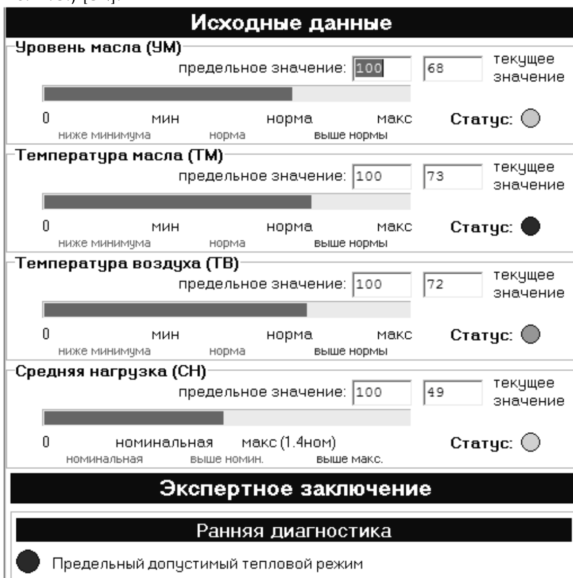
Рисунок 1.6 – Модель-заключение экспертной системы о режимах и состоянии силового трансформатора
