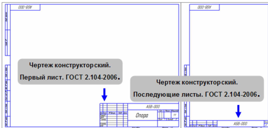
Рисунок 5.19 – Оформление листов чертежей конструкторских
