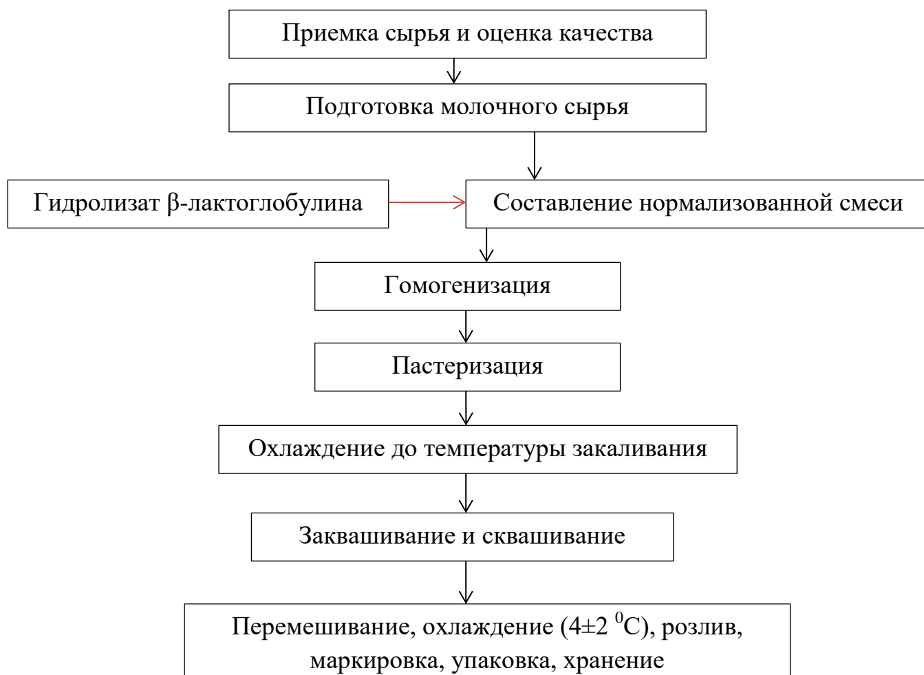
Рисунок 7 – Принципиальная технологическая схема производства кисломолочных напитков со сниженной аллергенностью молочного белка
