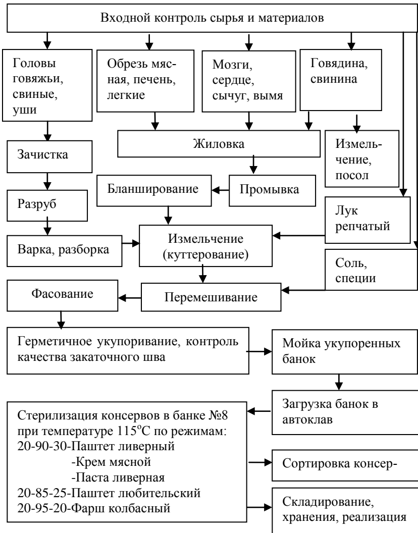
Рисунок 10– Технологическая схема производства консервов «Паштет любительский», «Паштет ливерный», «Крем мясной», «Паштет особый», «Фарш колбасный», «Паста ливерная».
