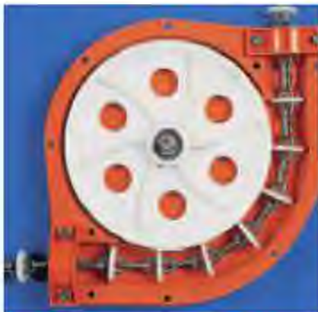
Рис. 3.10. Поворотное устройство кормораздатчика Драй Ратид
