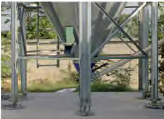
Рис. 9.5. Взвешивание бункера электронными тензодатчиками
