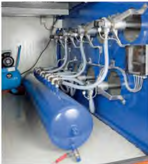
Рис. 11.26. Система очистки фильтра сжатым воздухом
