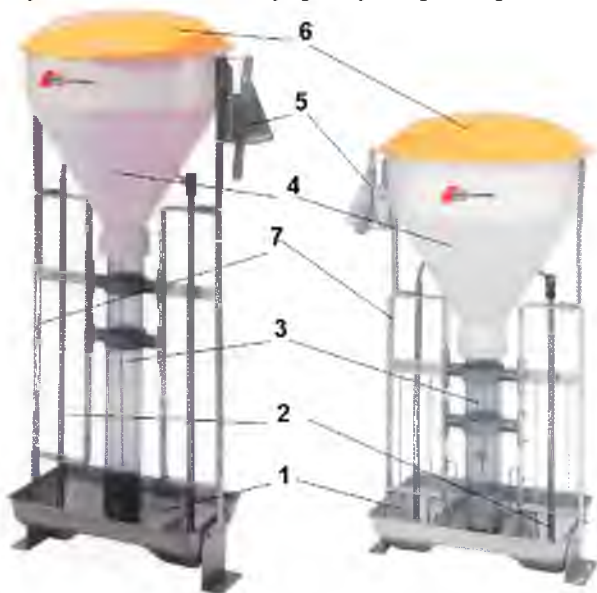
Рис. 3.5. Бункерные самокормушки MaxiMat компании Skold, установленные в групповых станках для доращивания поросят: 1 – корыто (поддон); 2 – автопоилки ниппельные; 3 – спускная (направляющая) труба; 4 – конический бункер; 5 – устройство для дозирования кормов; 6 – крышка откидная; 7 – каркас
