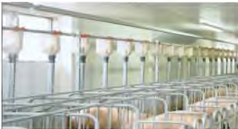
Рис. 3.11. Объемные дозаторы, установленные в свиарнике-маточнике
