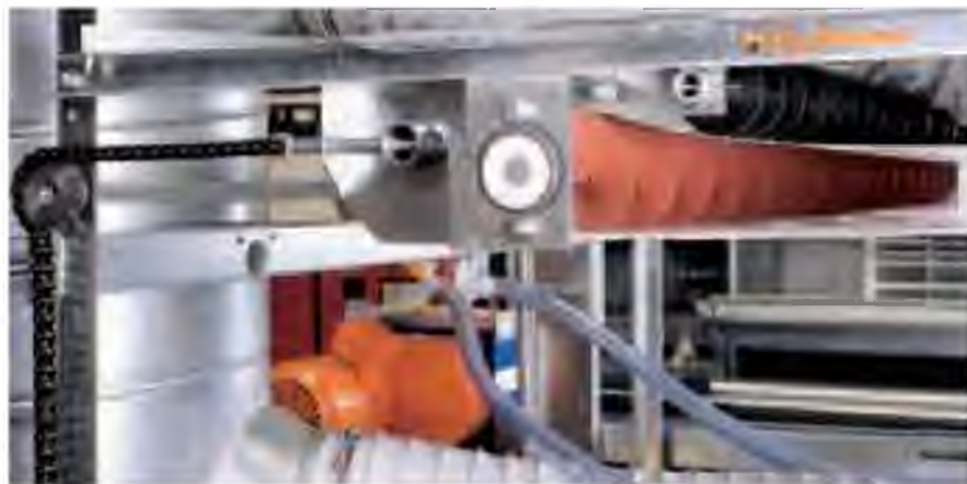
Рис. 7.1.4 Поворотная станция пометоудаления с очищающим шнеком
