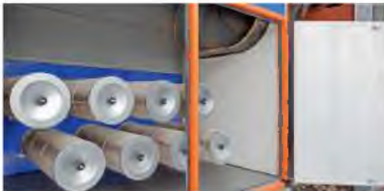
Рис. 11.25. Фильтр из целлюлозы для очистки отработанного воздуха
