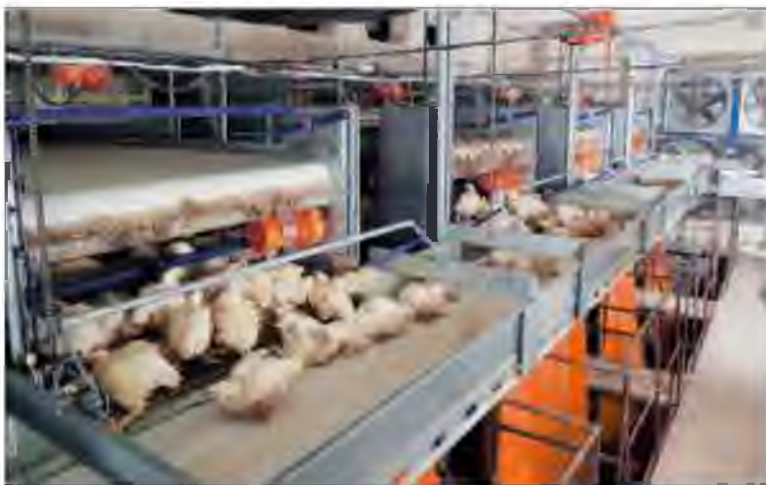
Рис. 7.16. Клеточная батарея с автоматической выгрузкой бройлеров
