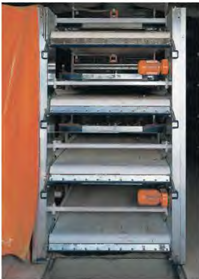
Рис. 7.8. Конечная станция пометоудаления с помето-приемной шахтой
