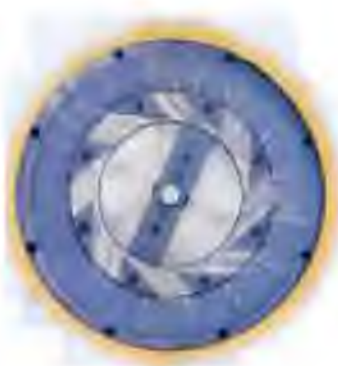
Рис. 2.2. Дисконая мельница Skiold: а – общий вид; б – принцип действия; в – мелющий диск
