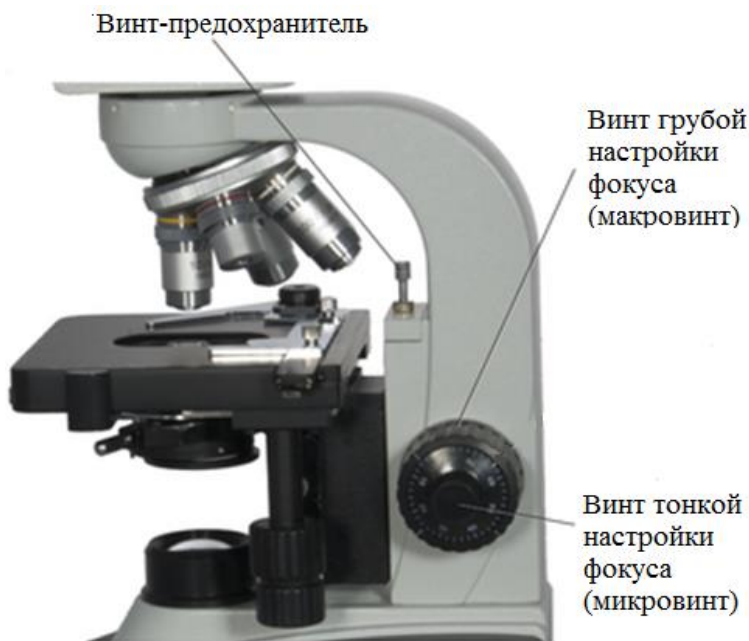
Рисунок 2 – Фокусирующий механизм микроскопа Биомед-5
