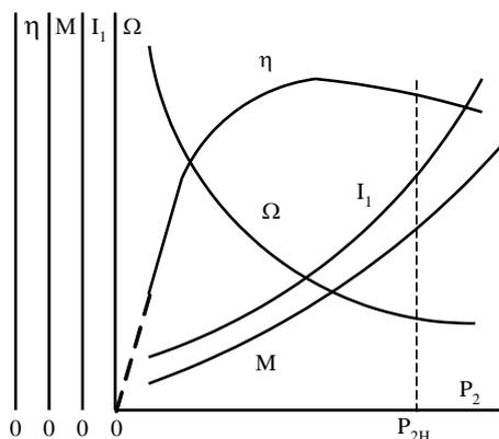
Рисунок 3.2 - Рабочие характеристики двигателя последовательного возбуждения
