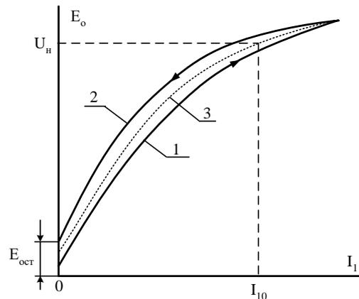
Рисунок 12.2 - Характеристика холостого хода синхронного генератора:
