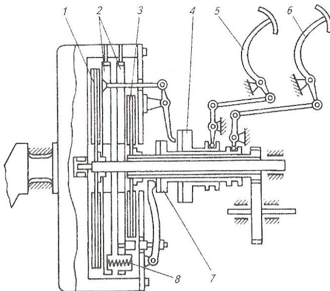
Рисунок 7.3 – Схема двухпоточного сцепления:
