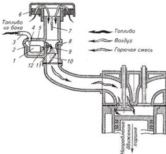
Рисунок 4.5 – Схема работы простейшего карбюратора:
