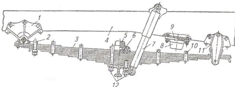
Рисунок 8.2 – Передняя подвеска автомобиля ЗИЛ-130:
