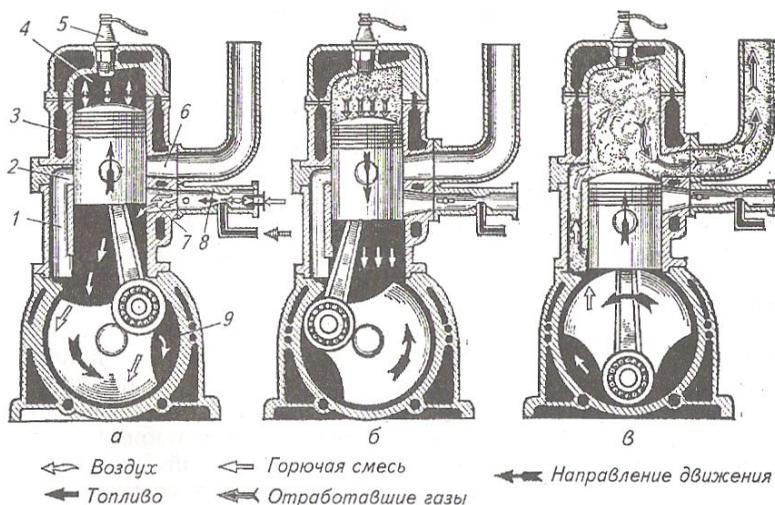
Рисунок 3.5 – Схема устройства и работы двухтактного карбюраторного двигателя:
