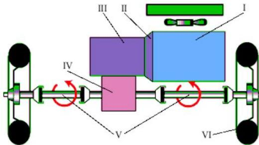
Рисунок 2.4 – Схема трансмиссии переднеприводного автомобиля:
