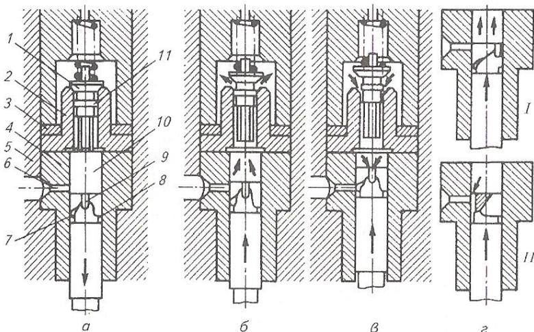
Рисунок 4.5 – Схема работы секции топливного насоса дизеля:
