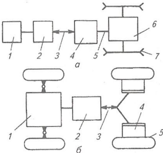
Рисунок 7.9 – Схемы трансмиссий различных типов:
