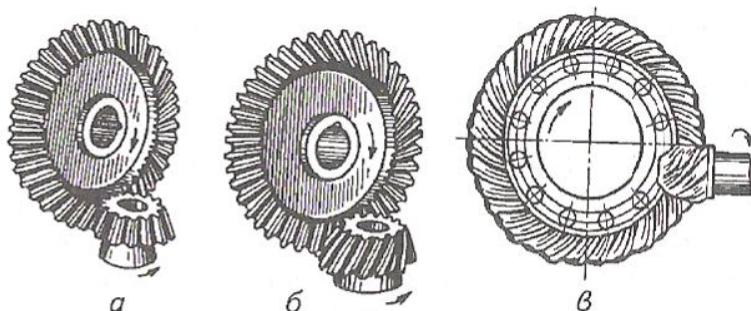
Рисунок 7.7 – Типы главных передач тракторов и автомобилей:
