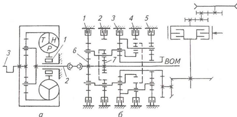
Рисунок 7.10 – Схема гидромеханической трансмиссии:
