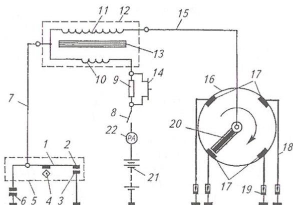
Рисунок 5.2 – Схема батарейной системы зажигания:
