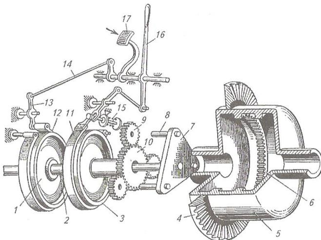
Рисунок 9.3 – Схема планетарного механизма поворота:
