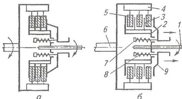
Рисунок 9.2 – Схема фрикционной муфты поворота:
