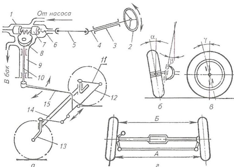
Рисунок 9.1 – Схемы рулевого управления и установки передних колес:
