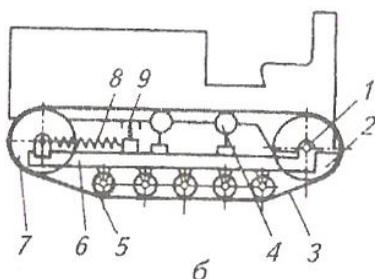
Рисунок 8.3 – Схемы подвесок гусеничных тракторов:
