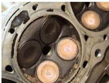
Рисунок 4.3 – Зависание клапанов в газораспределительном механизме
