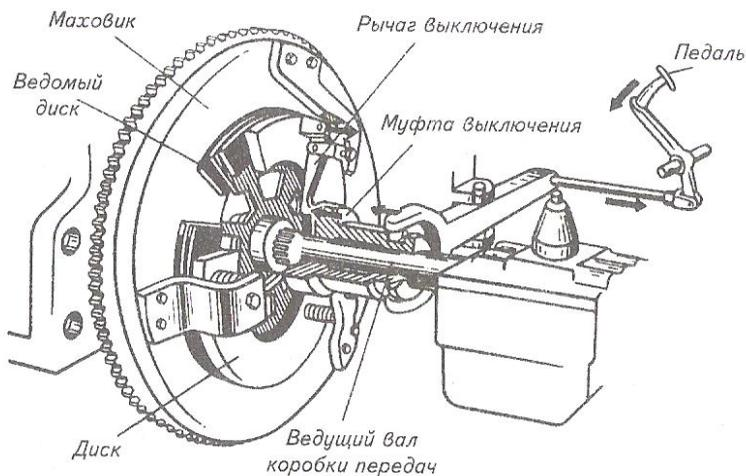
Рисунок 7.2 – Принципиальная схема сцепления
