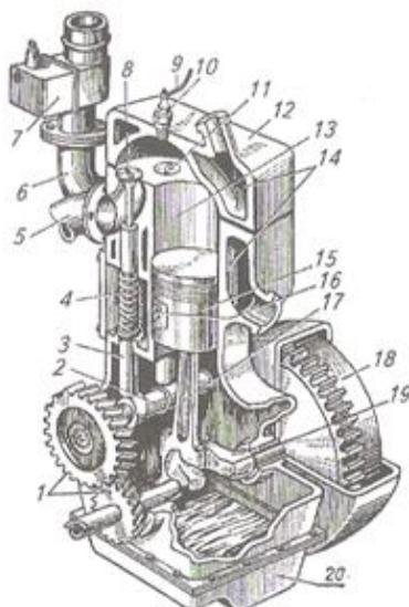
Рисунок 3.1 – Устройство одноцилиндрового четырехтактного карбюраторного двигателя:
