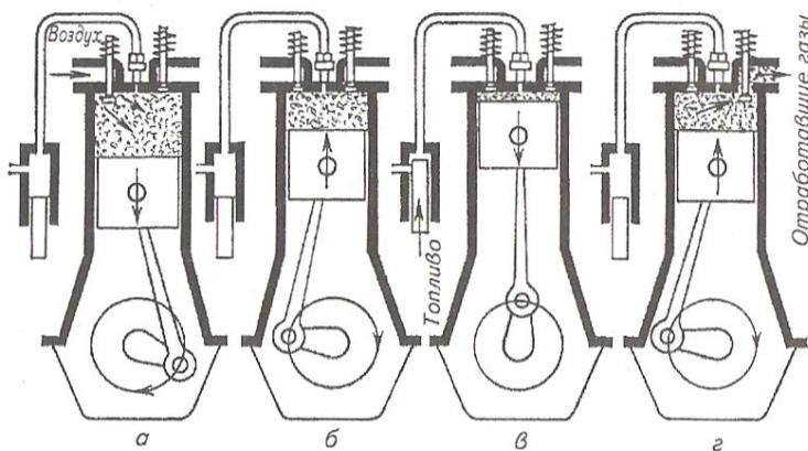
Рисунок 3.4 – Рабочий цикл одноцилиндрового четырехтактного дизеля:
