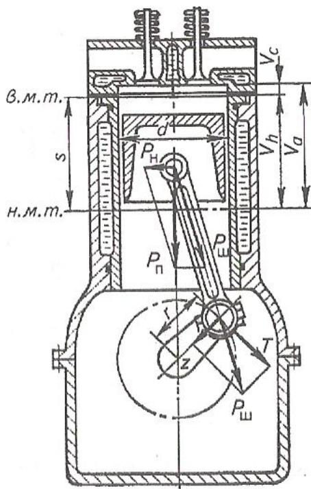
Рисунок 3.2 – Схема одноцилиндрового четырёхтактного двигателя
