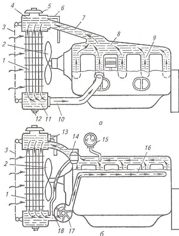
Рисунок 4.8 – Схемы жидкостной системы охлаждения:
