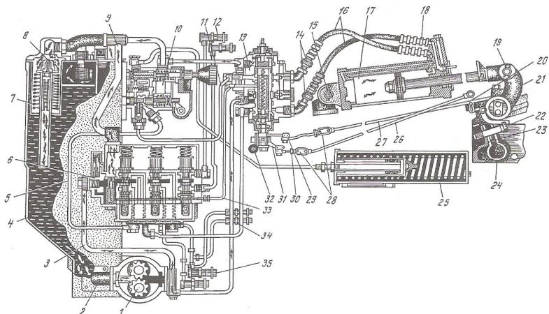
Рисунок 10.4 – Схема гидросистемы трактора:
