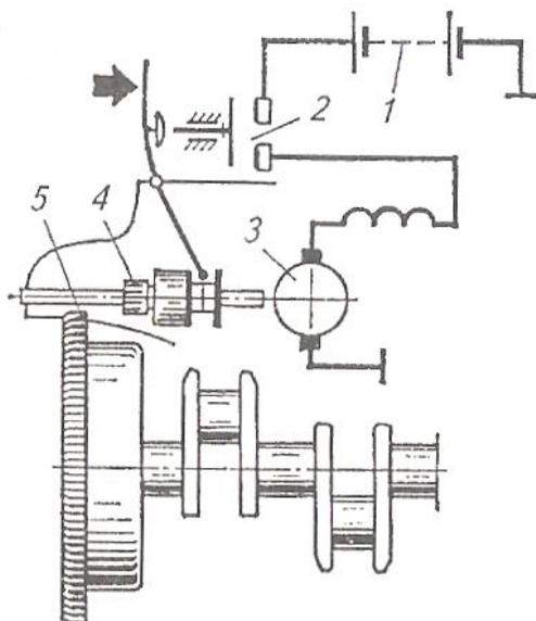
Рисунок 5.1 Схема пуска электрическим стартером:
