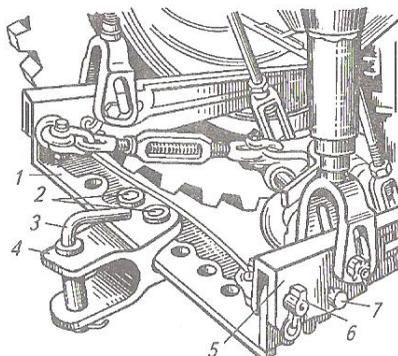
Рисунок 10.6 – Прицепное устройство тракторов
