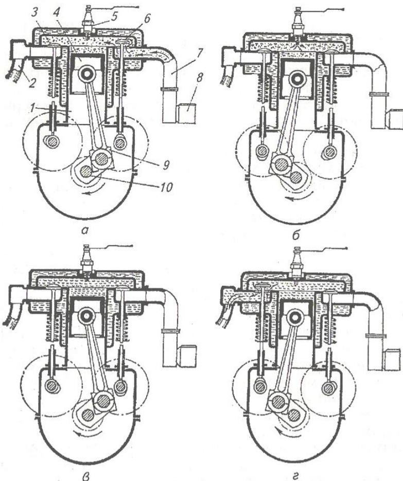
Рисунок 3.3 – Рабочий цикл одноцилиндрового четырехтактного карбюраторного двигателя:
