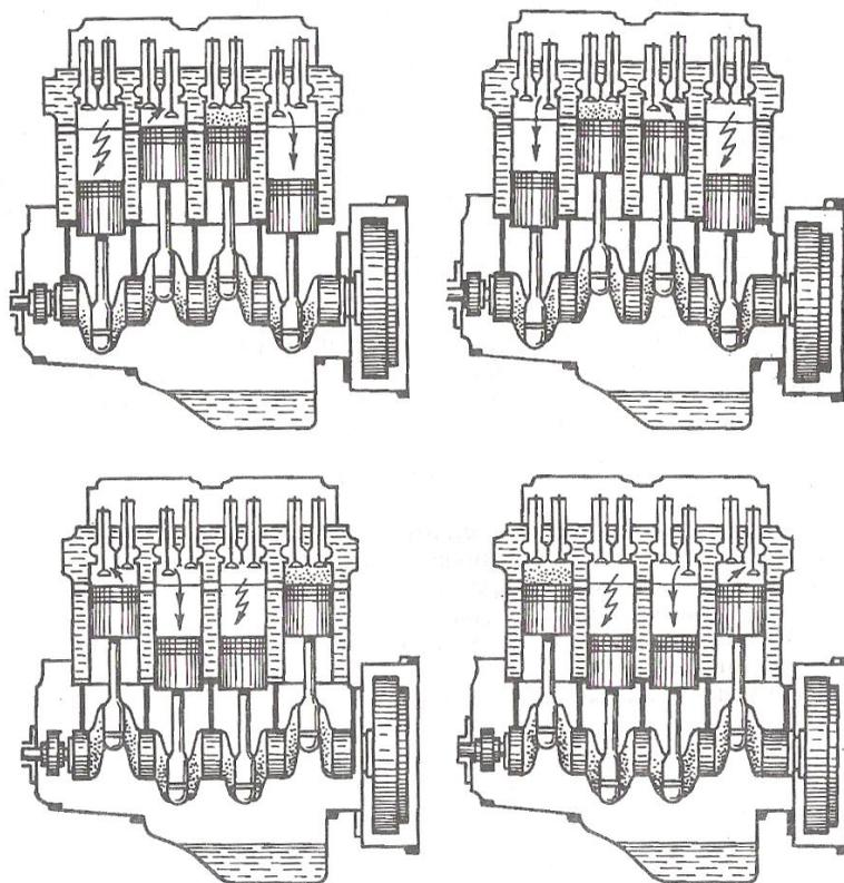
Рисунок 3.7 – Работа четырехцилиндрового четырехтактного двигателя (порядок работы 1–3–4–2)
