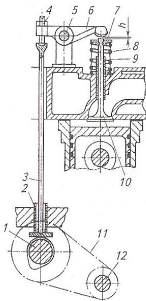
Рисунок 4.2 – Механизм газораспределения и его детали:
