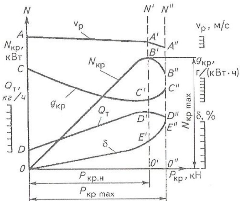
Рисунок 12.1 – Тяговая характеристика трактора на одной передаче
