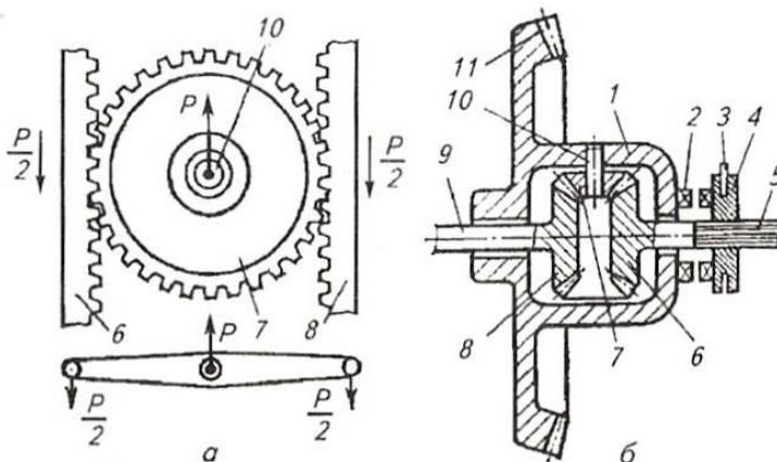
Рисунок 7.8 – Схема дифференциала и механизма его блокировки:
