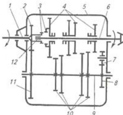
Рисунок 7.6 – Кинематическая схема трехвальной КПП с прямой передачей:
