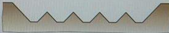
Профиль дна борозды после рыхления почвы чизельным плугом
