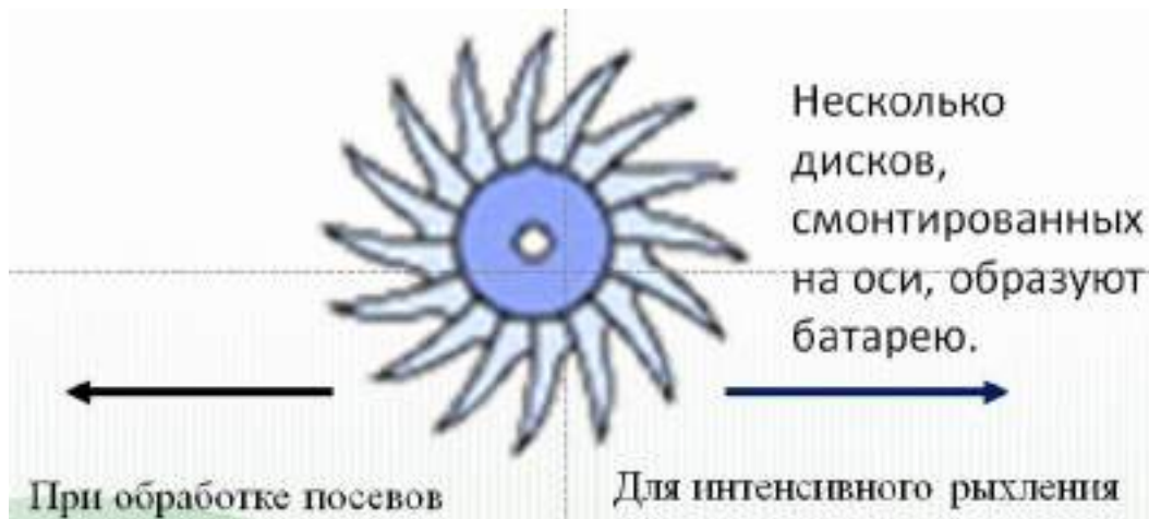
Рисунок 2.5 Рабочий орган ротационной мотыги
