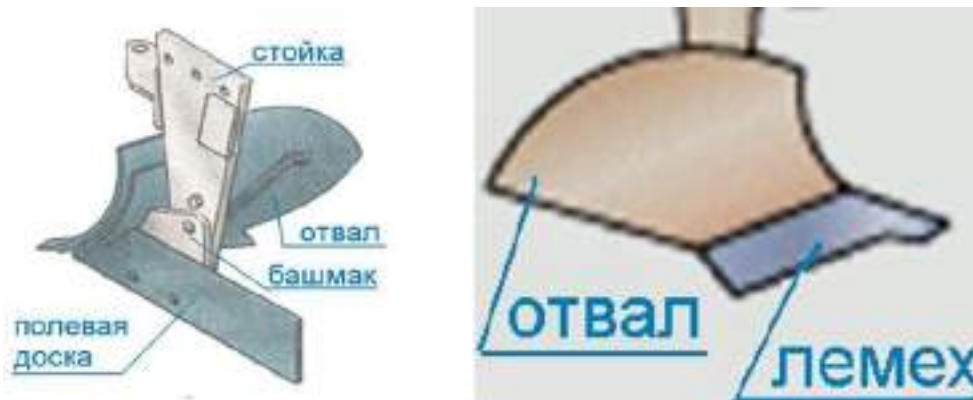
Рисунок 1.6 Составные элементы корпуса плуга
