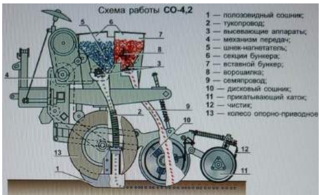
Рисунок 4. 12 Технологическая схема работы овощной сеялки СО-4,2
