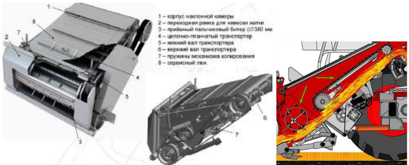
Рисунок 8.12 Устройство наклонной камеры комбайна VECTOR 410
