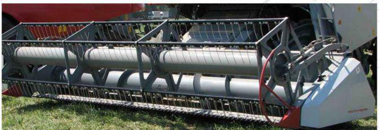
Рисунок 8.7 Универсальная жатка Power Stream обеспечивающая непрерывный поток
