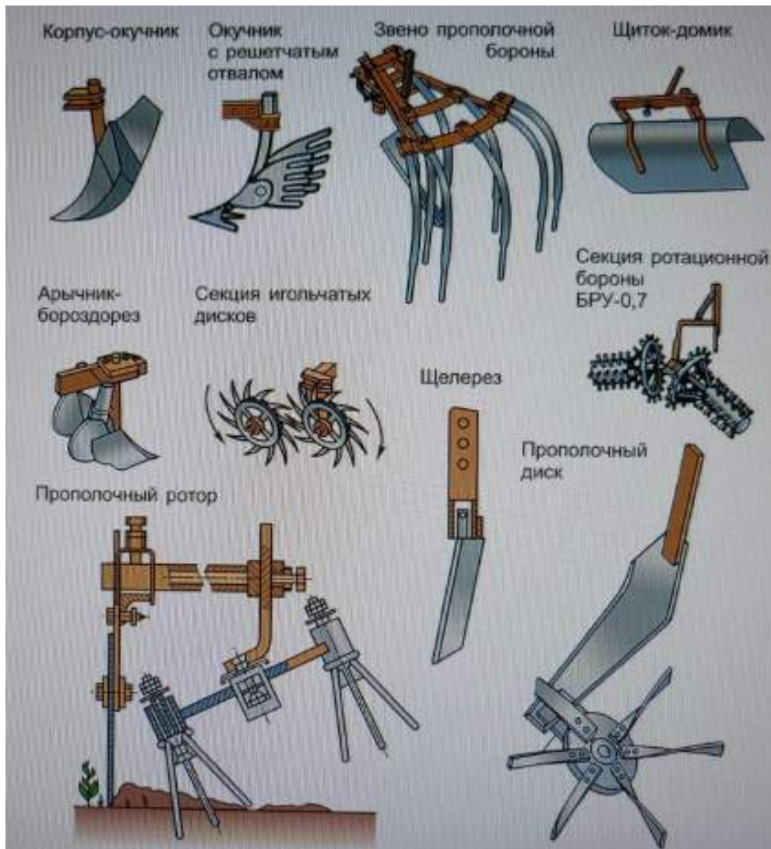
Рисунок 5.2 Рабочие органы пропашных культиваторов (часть 2)
