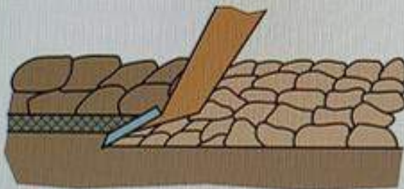
Разрушение плужной подошвы при глубокой обработке почвы чизельным плугом
