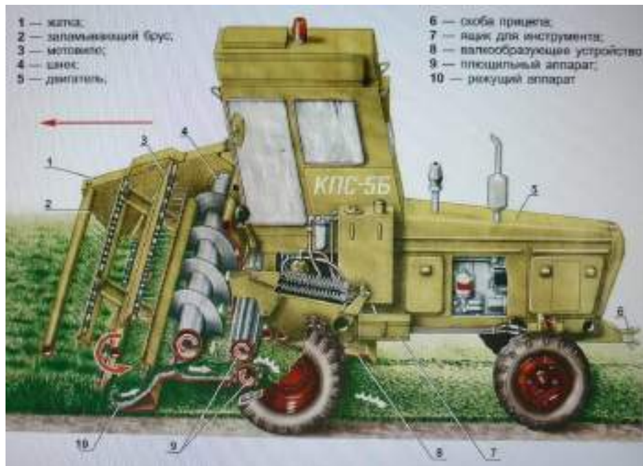
Рисунок 7.5 Схема рабочего процесса косилки-плющилки КПС-5Б
