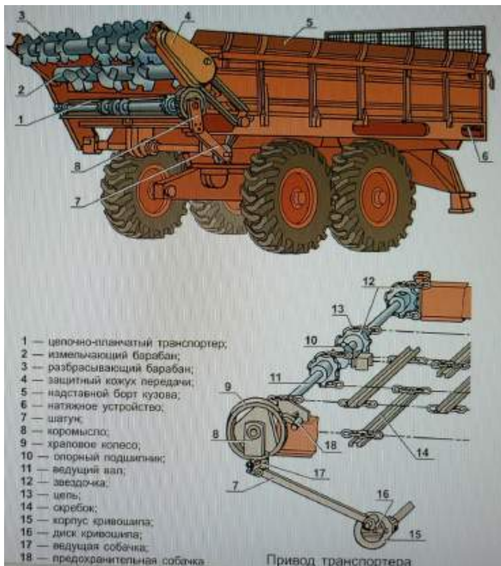
Рисунок 3.12 Общий вид машины для внесения твёрдых органических удобрений РОУ - 6
