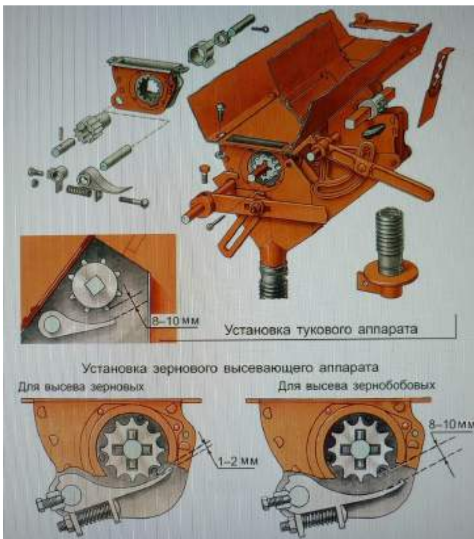
Рисунок 4. 3 Регулировки катушечных высевающих аппаратов
