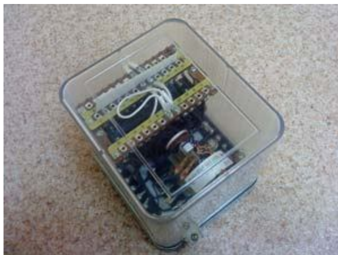
Рисунок 6.1 – Внешний вид устройства реле типа РНТ-565
