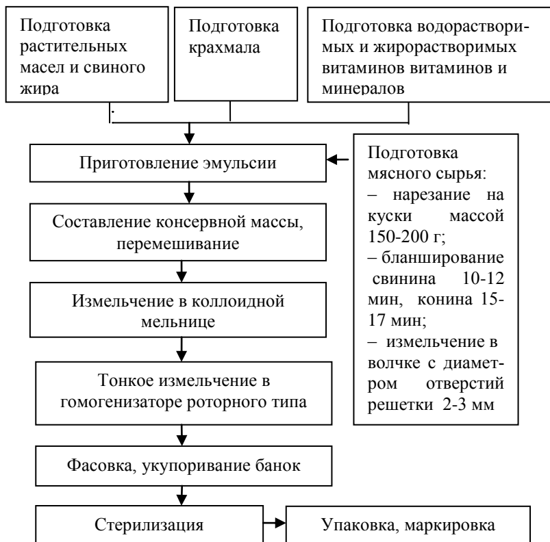
Рисунок 4 - Технологическая схема производства белково-жирового комплекса для питания детей грудного возраста.
