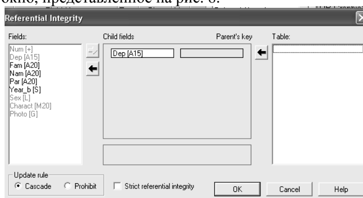
Рис.8. Окно установления целостности на уровне ссылок
