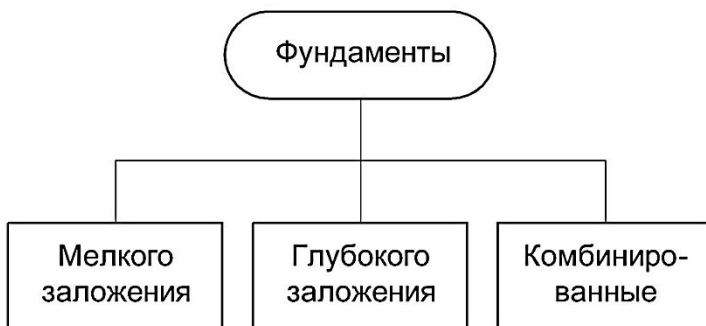
Рисунок 1.7 – Классификация видов фундаментов зданий и сооружений
