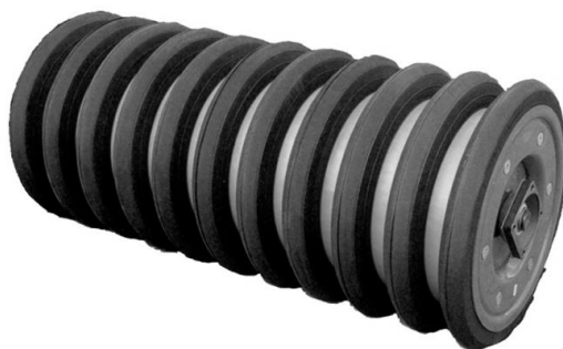
Рисунок 10.2 – Катки с клиновыми кольцами дисковой бороны Catros фирмы Amazone (ФРГ)
