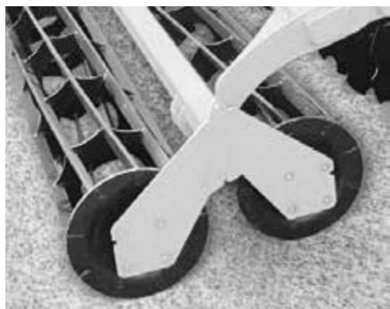
Рисунок 10.4 – Двухрядный планчатый прикатывающий каток
