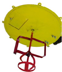
Рисунок 2 – Дозирующее устройство сеялок: а – ГНОМ-1; б – ГНОМ-2
