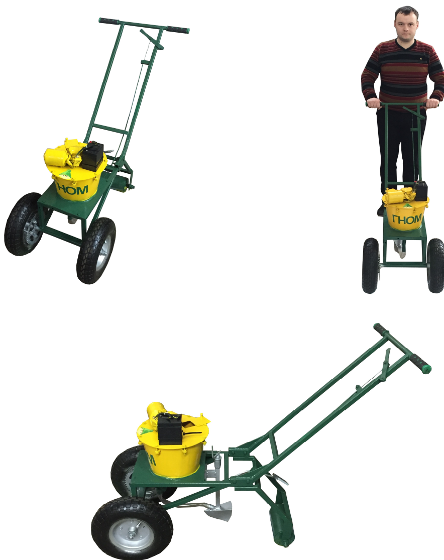
Рисунок 1 – Сеялка для рядкового посева семян овощных культур с электроприводом дозирующего устройства
