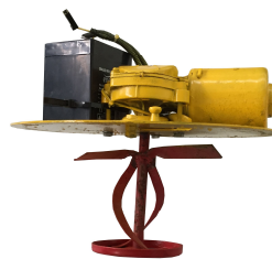
Рисунок 2 – Дозирующее устройство сеялок: а – ГНОМ-1; б – ГНОМ-2
