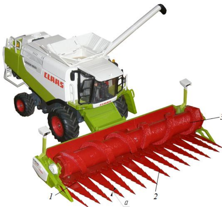
Рисунок 3 – Модернизация жатки Vario 900 к комбайну Lexion 620:
