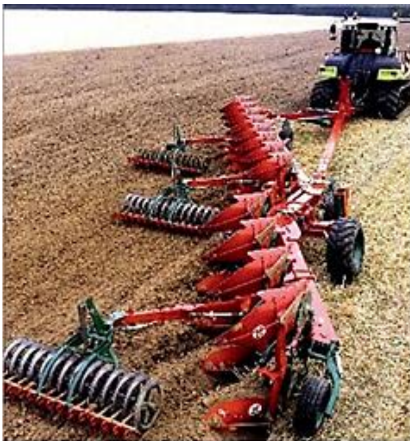
Рисунок 2.2 – Многокорпусный плуг с дополнительными катками для крошения почвы фирмы Kverneland (Норвегия)
