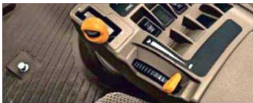
Рисунок 1.8 – Управление трансмиссия Power Shift с 18 передачами переднего и 6 передачами заднего хода
