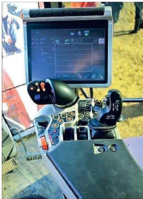
Рисунок 1.22 – Центральная панель управления тракторов Kubota M7
