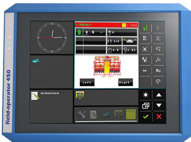
Рисунок 8.1– Терминал ISOBUS для реализации межфирменной концепции управления машинно-тракторными агрегатами
