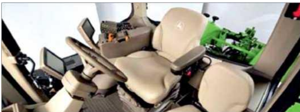
Рисунок 1.7 – Кабина CommandView II с сиденьем ActiveSeat
