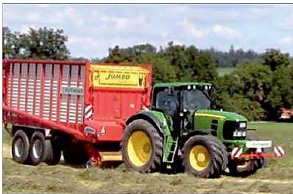
Рисунок 8.7 – Полуприцеп подборщик фирмы Pottinger с электронной системой регулирования скорости движения
