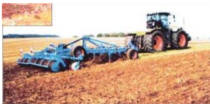
Рисунок 2.4 – Система для поддержания заданной глубины обработки в соответствии с рельефом фирмы Lemken GmbH & Co. KG
