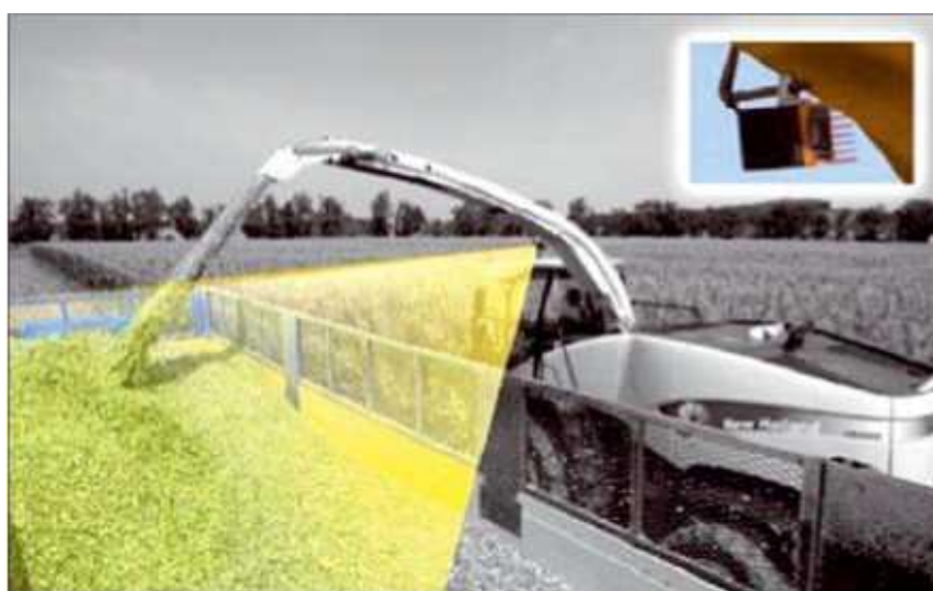
Рисунок 8.6 – Система автоматического наведения силосопровода на прицеп фирмы New Holland
