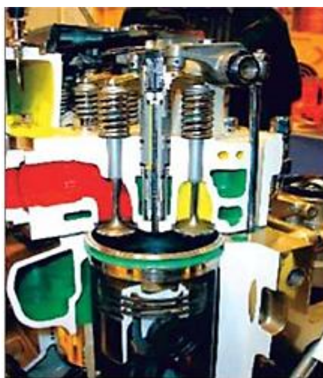
Рисунок 1.25 – Двигатель с четырьмя клапанами на цилиндр в системе газораспределения
