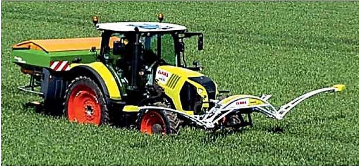
Рисунок 4.10 – Сенсорный датчик CROP SENSOR ISARIA
