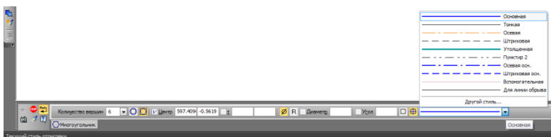
Рисунок 6.31 – Панель видов линии при построении многоугольника
