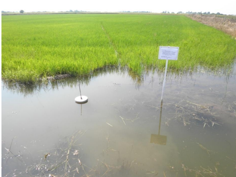
Рисунок 6.10 – Дискретный регулятор в режиме сработки уровня на экспериментальном участке РОС ГНУ ВНИИриса
