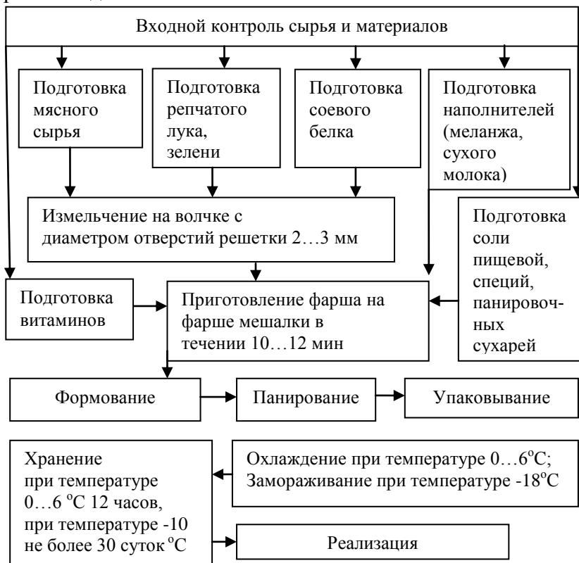
Рисунок 2 - Технологическая схема производства мясных рубленых полуфабрикатов для детского питания
