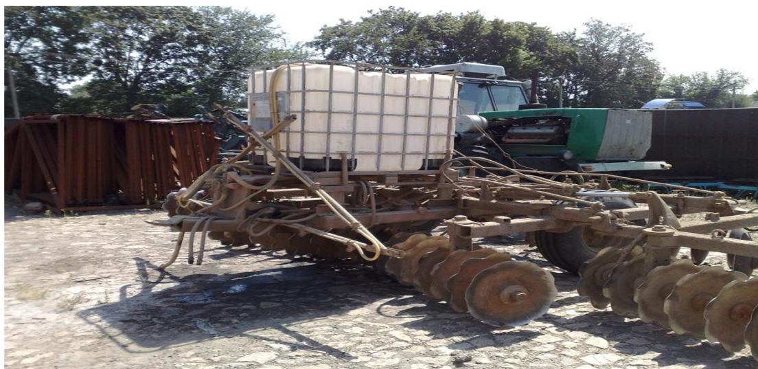
Рисунок 21/II – Переоборудованный под внесение микробиологических препаратов дискатор
