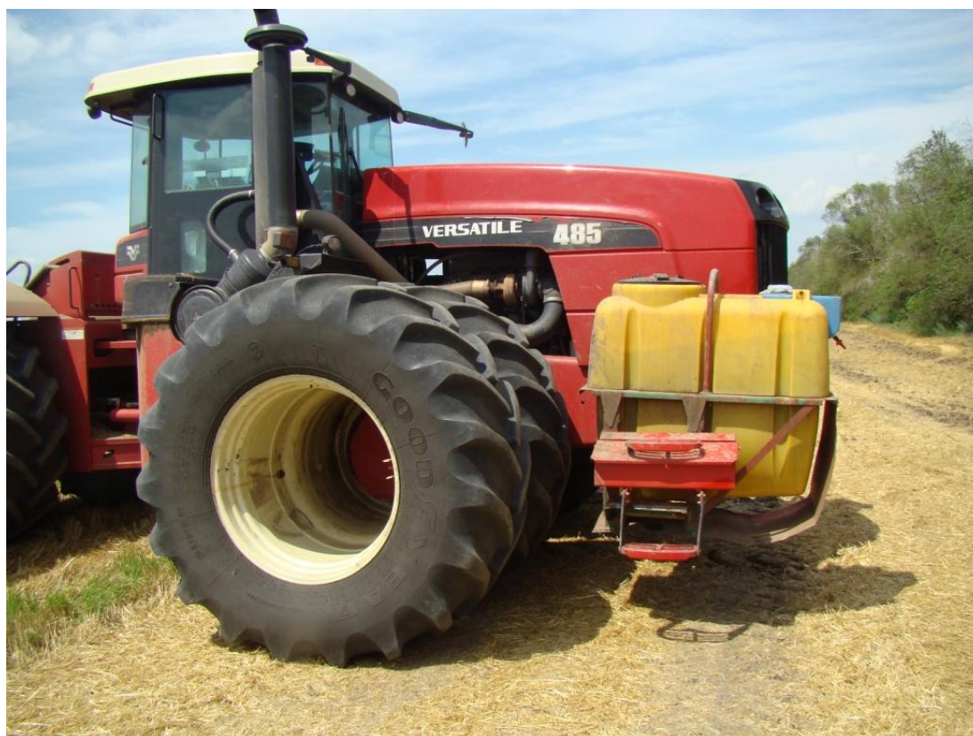
Рисунок 21/II – Навеска ёмкости для рабочего раствора на трактор
