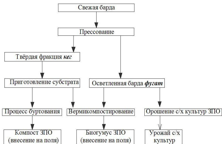
Рисунок 5.1 - Схема утилизации отходов производства спирта
