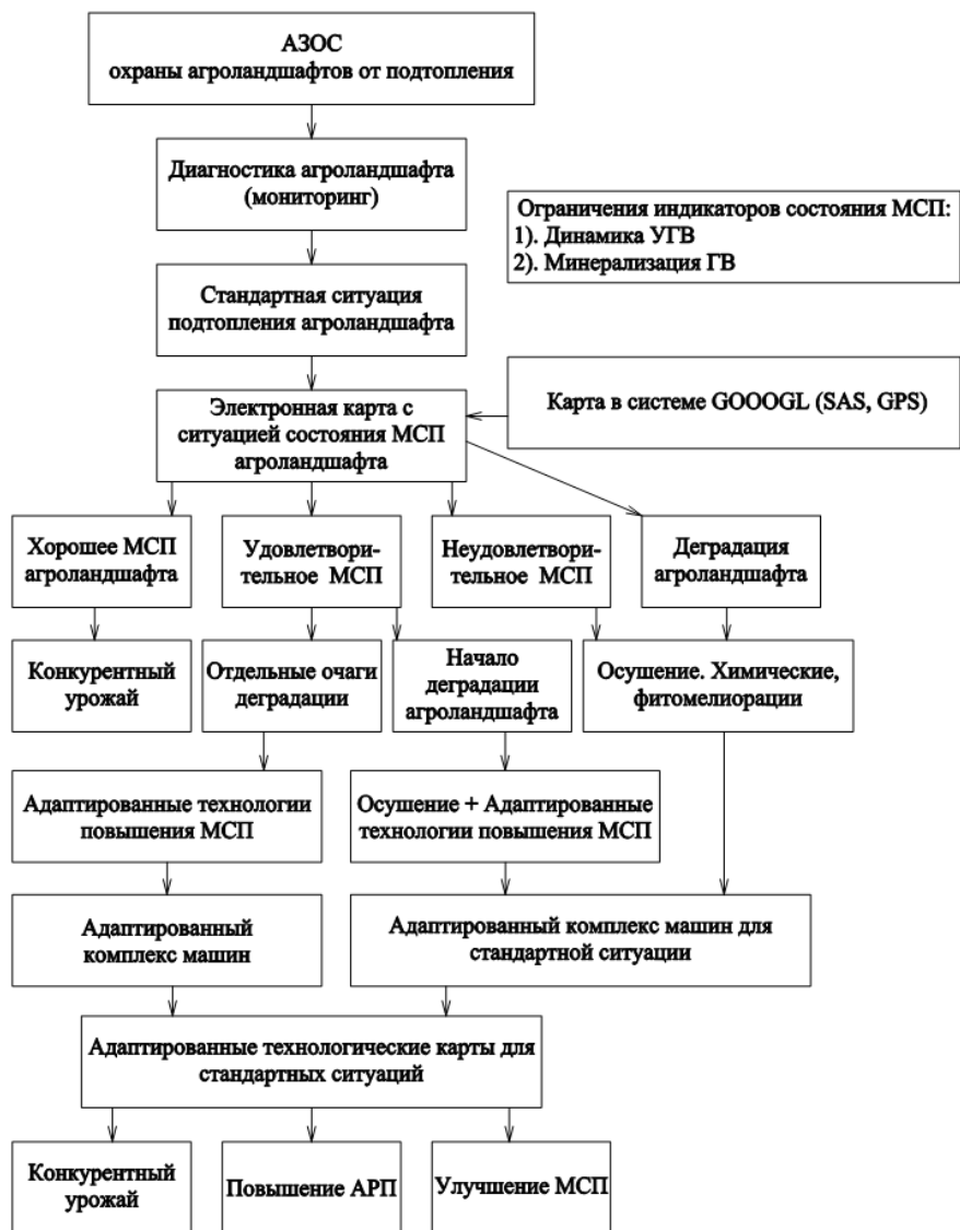
Рисунок 3.1 - Блок-схема АЗОС охраны агроландшафтов от подтопления и переувлажнения
