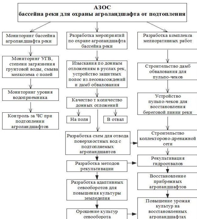
Рисунок 3.13 – Структура АЗОС бассейна реки для охраны агроландшафтов от подтопления и переувлажнения
