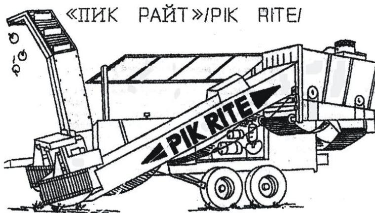
Рисунок 6.4 Схема прицепного томатоуборочного комбайна Пик Райт (США)
