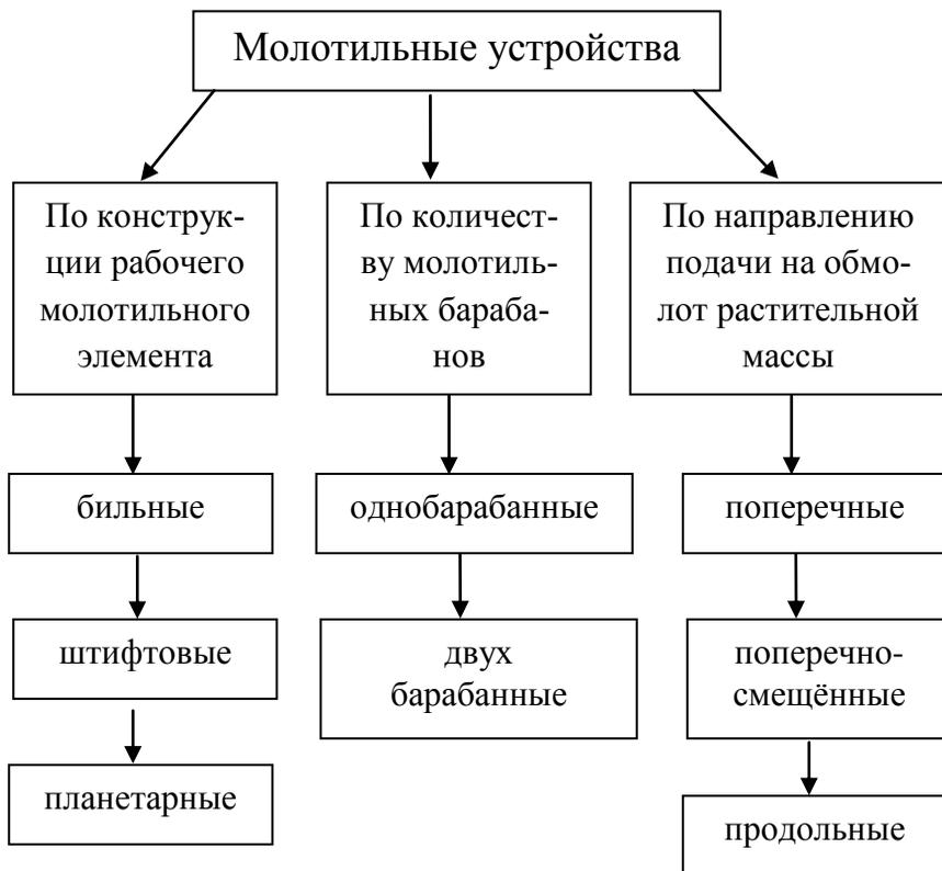
Рисунок 1.7 Классификация молотильных установок
